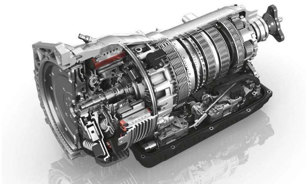
Slika 5. Hibridni modul i sklop prijenosa snage [3]
