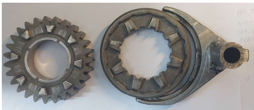
Slika 36. Zupčanik sa kandžama i kandžasta spojka
