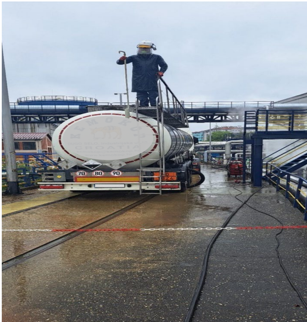
Slika 11. Uzimanje uzorka iz cisterne [17]
