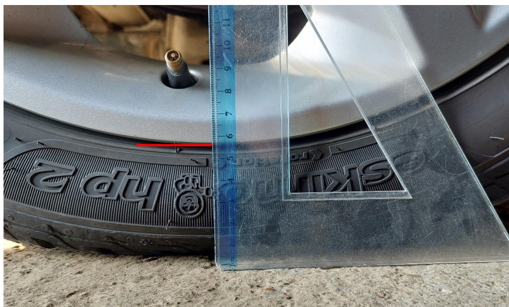
Slika 12. Bočnica gume pri tlaku od 1,9 bara
