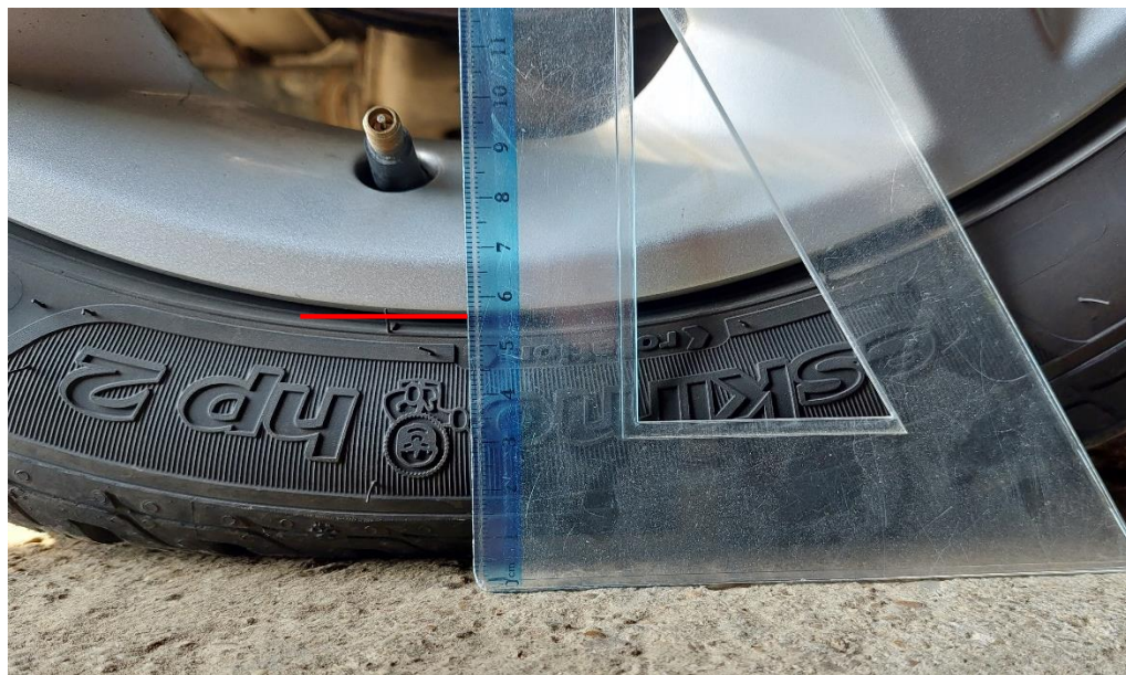
Slika 12. Bočnica gume pri tlaku od 1,9 bara
