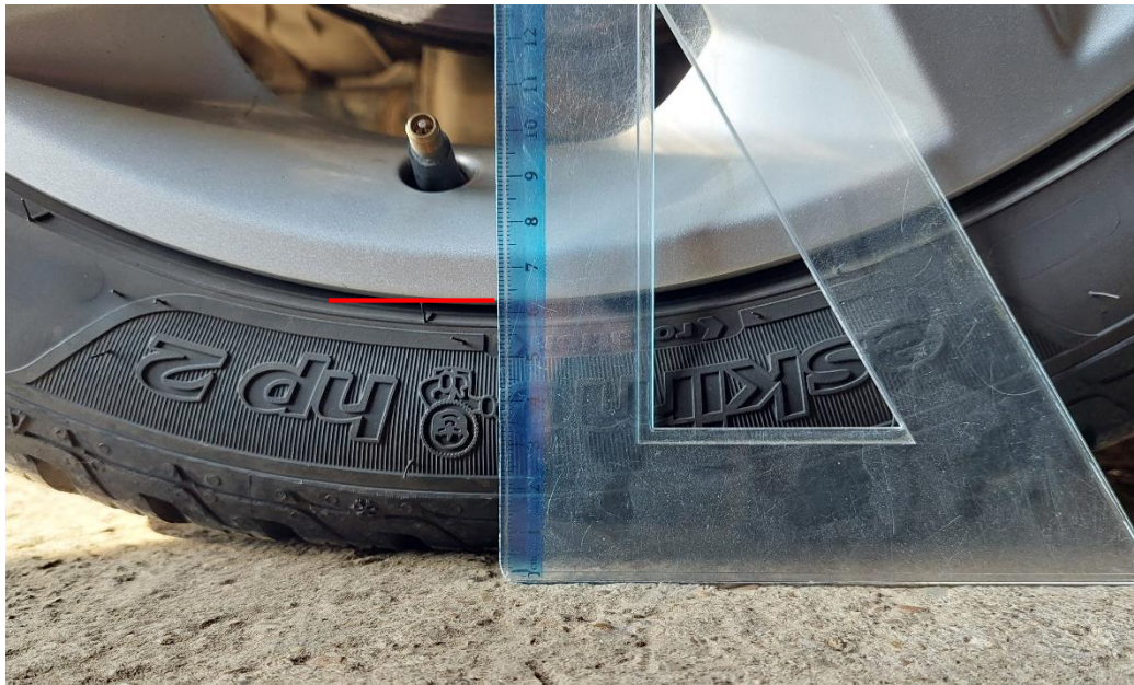
Slika 13. Bočnica gume pri tlaku od 2,7 bara
