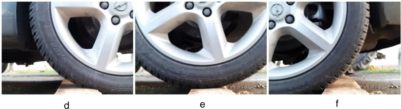
Slika 27. Položaji stražnjeg kotača tijekom prijelaza preko neravnine
