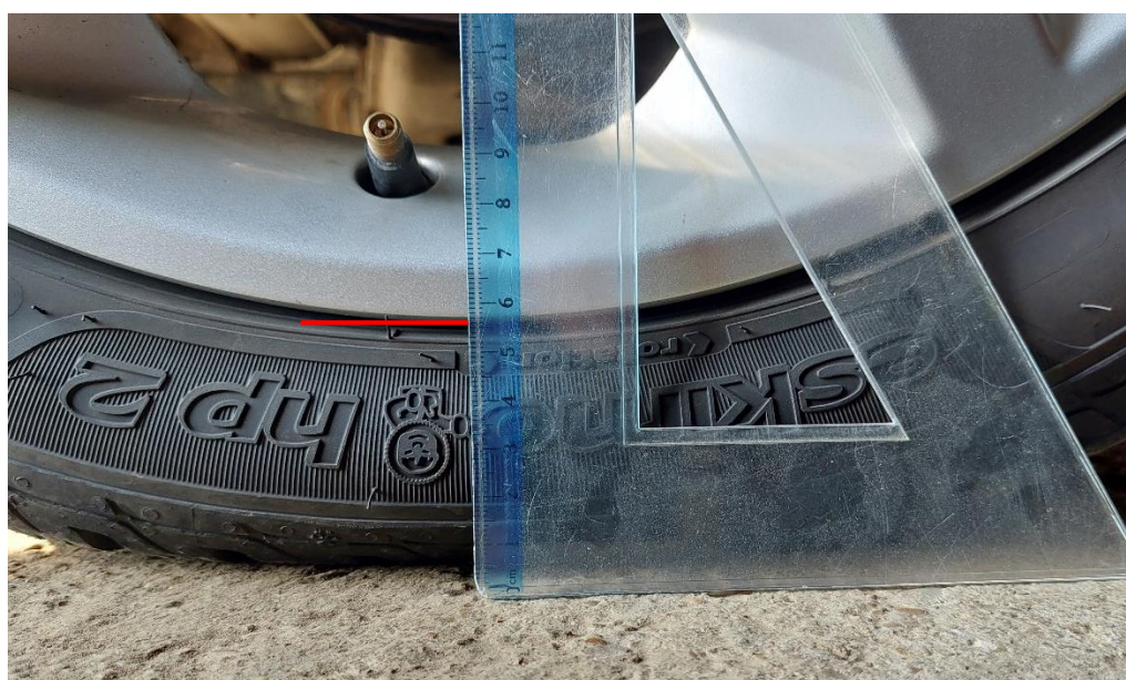
Slika 12. Bočnica gume pri tlaku od 1,9 bara
