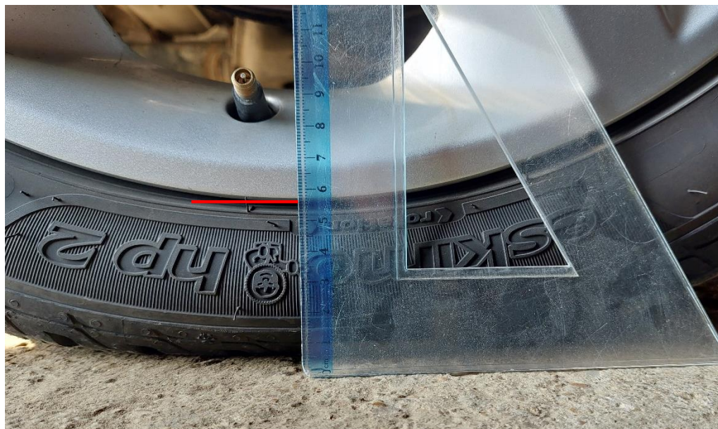
Slika 12. Bočnica gume pri tlaku od 1,9 bara
