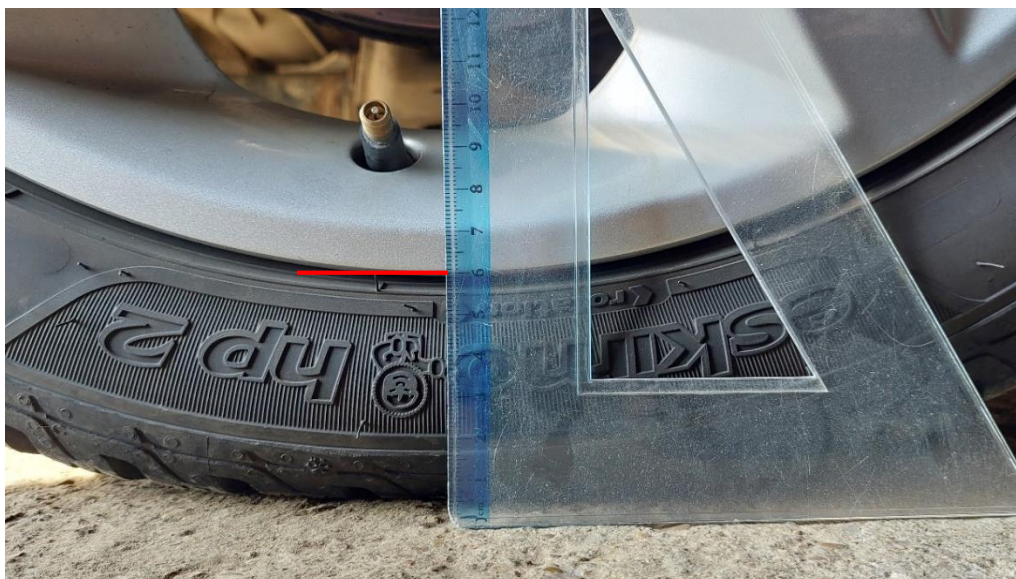
Slika 11. Bočnica gume pri tlaku od 2,3 bara
