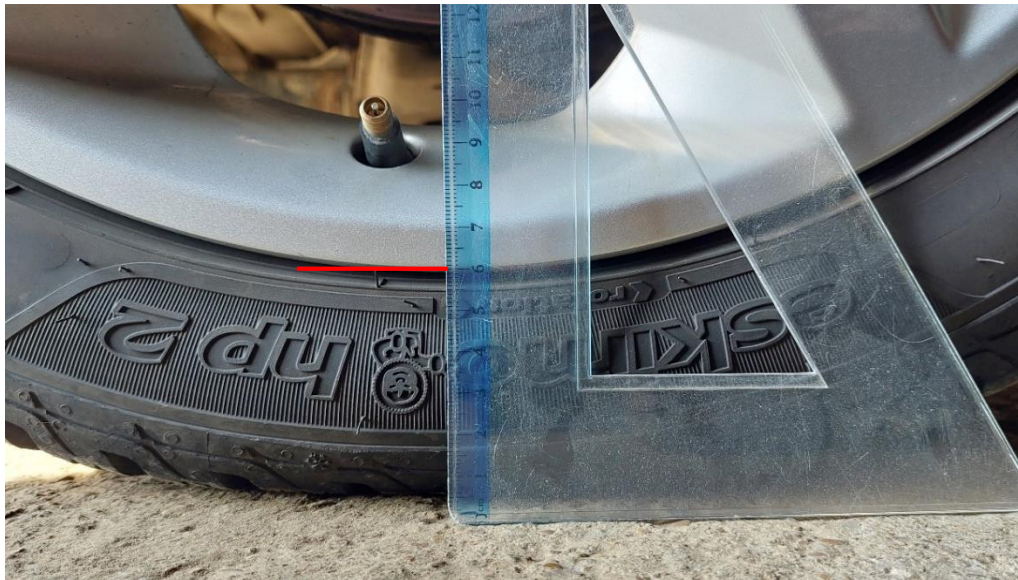
Slika 11. Bočnica gume pri tlaku od 2,3 bara
