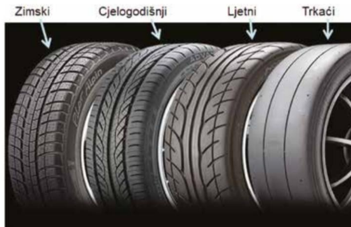
Slika 5. Vrste pneumatika po namjeni [1]
