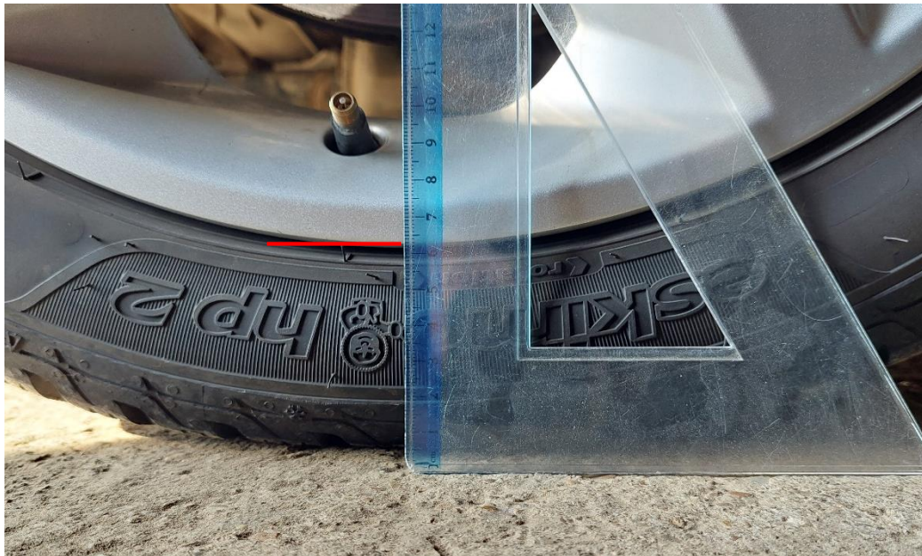
Slika 13. Bočnica gume pri tlaku od 2,7 bara
