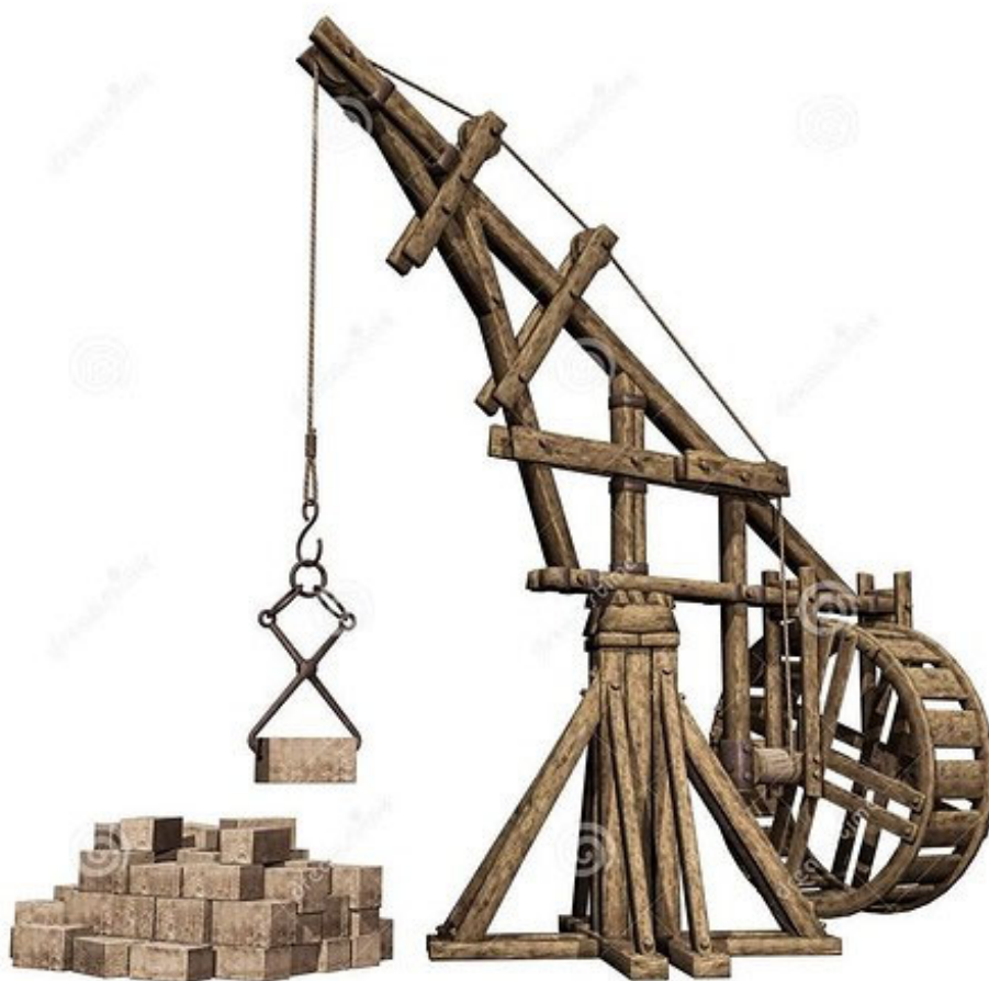
Slika 3 - Drveni kran sa vodenim kolom [2]
