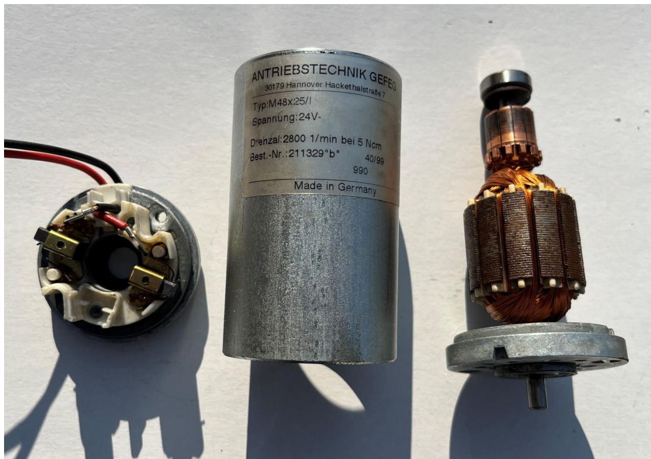
Slika 25: Predodžba rastavljenog motora. Izvorno autor.
