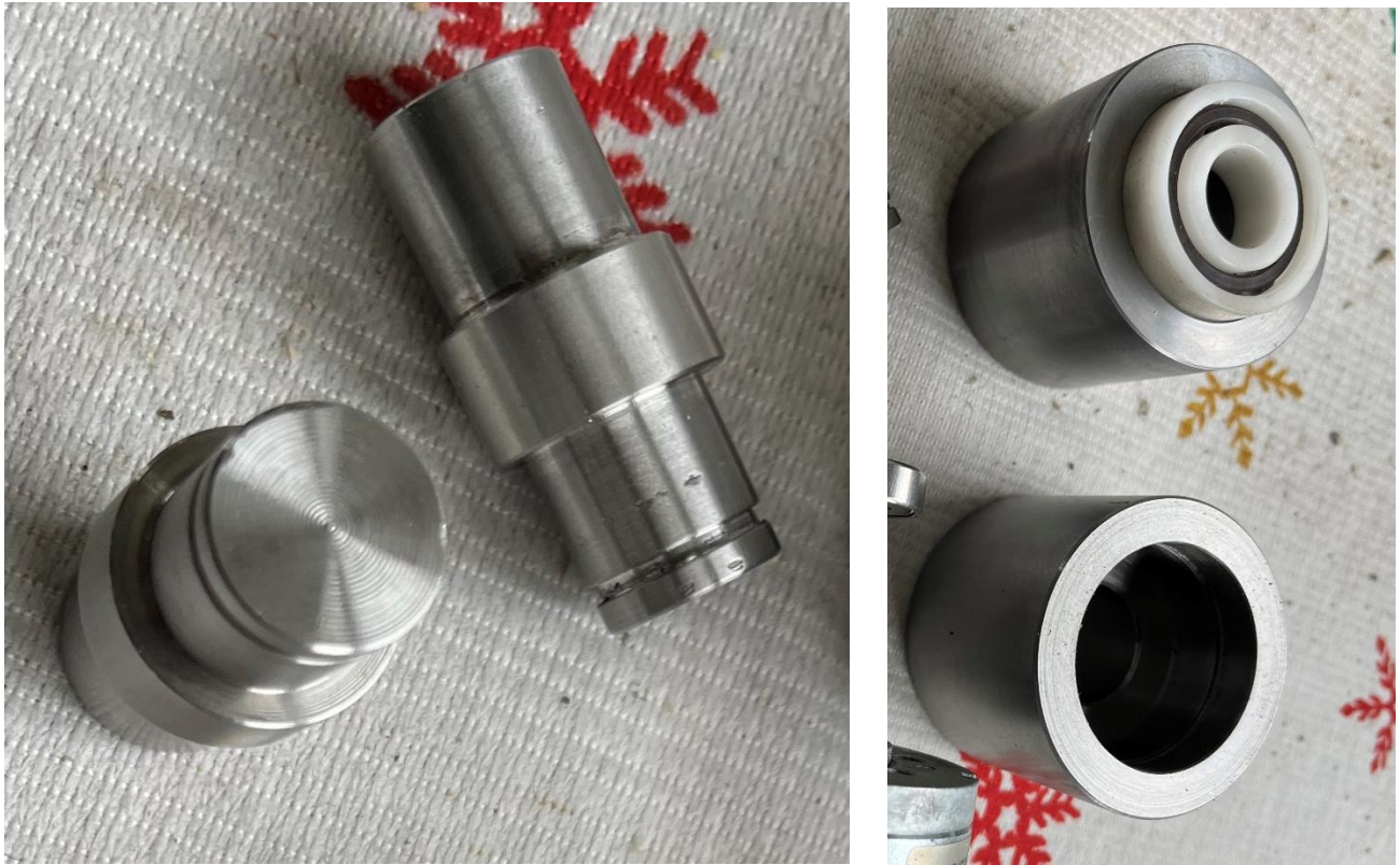
Slika 36: Predodžba pripreme za ležajeve. Izvorno autor.
