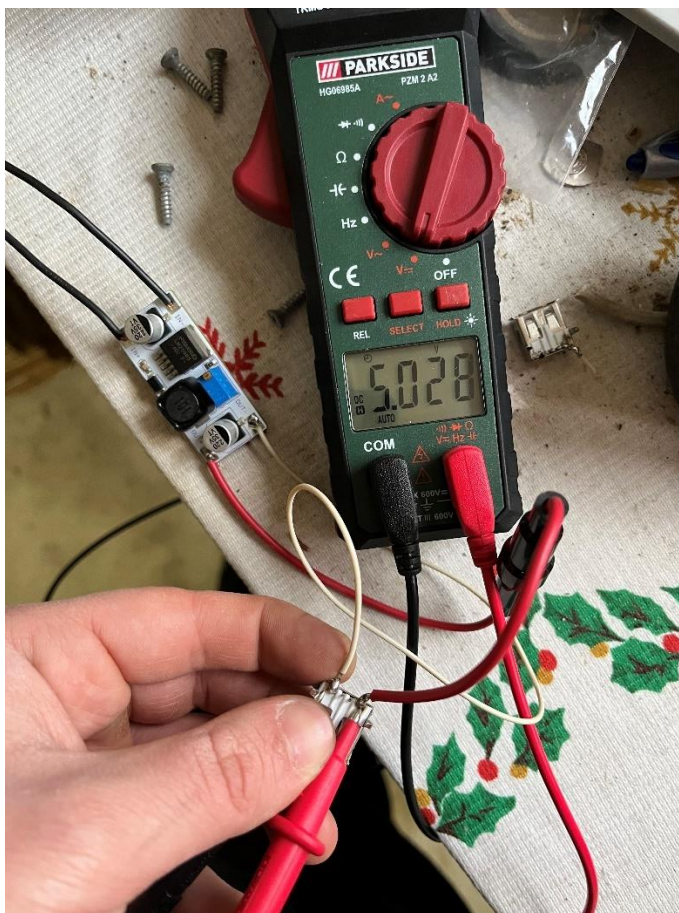
Slika 42: Predodžba izmjerenog izlaznog napona pretvarača. Izvorno autor.
