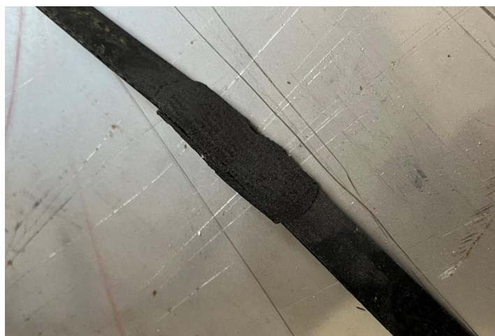
Slika 30: Predodžba vulkanizacije remena. Izvorno autor.
