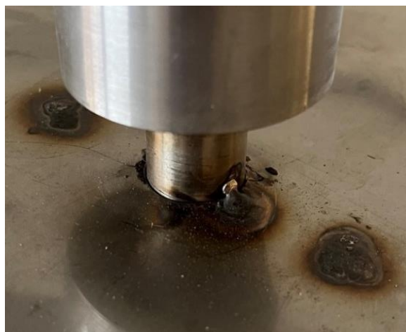
Slika 22: Predodžba zavara osovine za lim. Izvorno autor.
