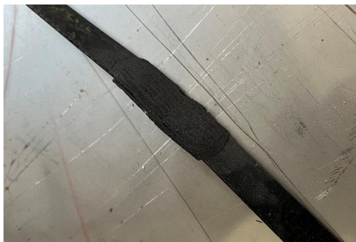
Slika 30: Predodžba vulkanizacije remena. Izvorno autor.
