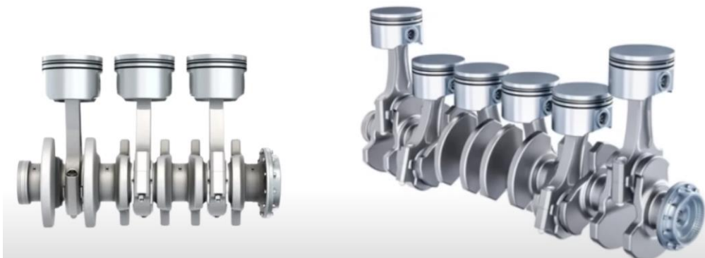
Slika 47. Raspored klipova u trocilindričnom i šesterocilindarskom motoru [8]
