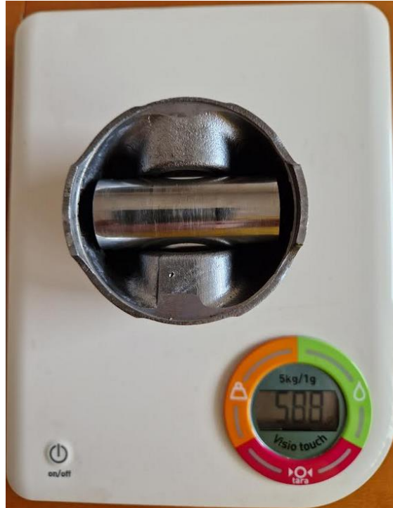
Slika 54. Vaganje klipa s zatikom
