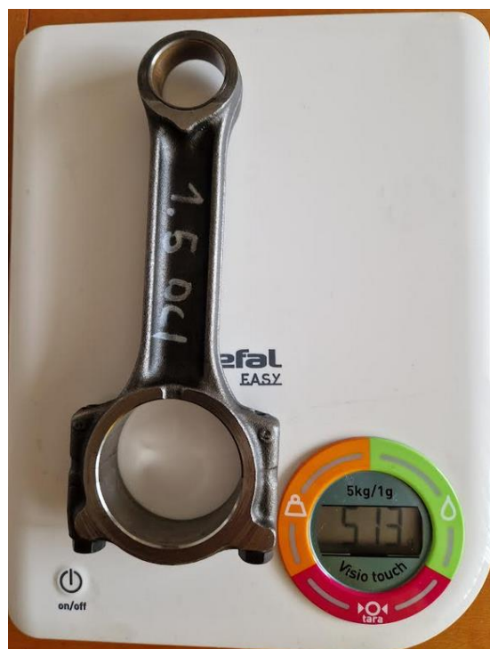
Slika 54. Vaganje ojnice (klipnjače)
