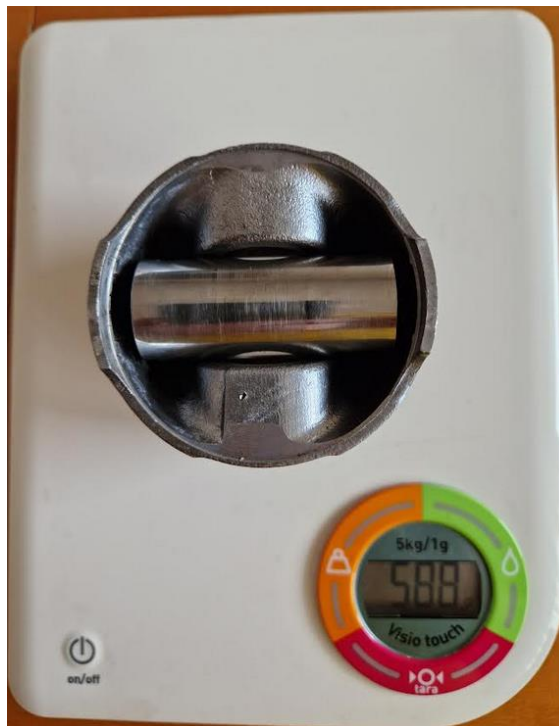
Slika 54. Vaganje klipa s zatikom
