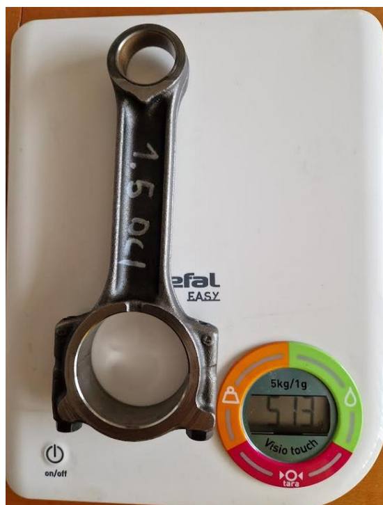
Slika 54. Vaganje ojnice (klipnjače)
