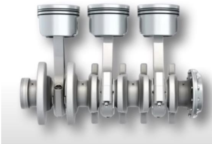
Slika 1. Redni trocilindarski motor [8]
