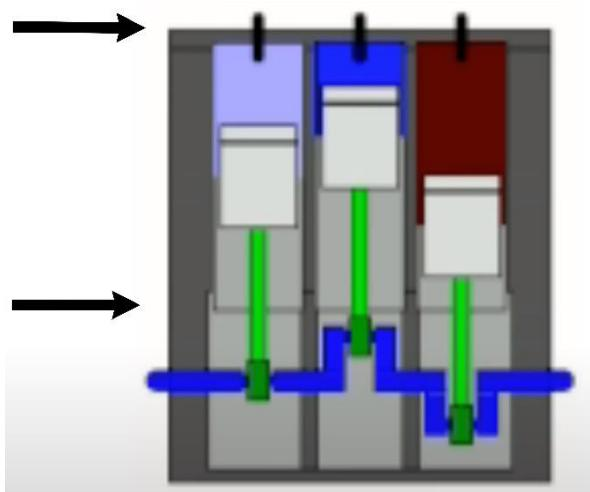
Slika 52. Gornja i donja mrvna točka hoda cilindara na trocilindarskom motoru [8]
