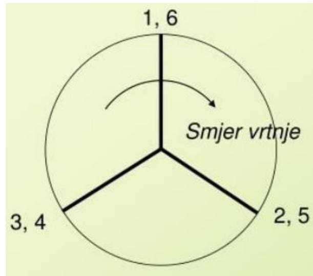
Slika 50. Zvijezda koljena II. reda za 4T šesterocilindrični motor [3]
