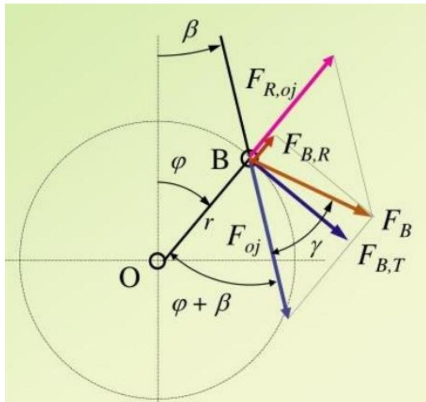
Slika 32. Rezultanta sile u točki B s njezinim komponentama [3]
