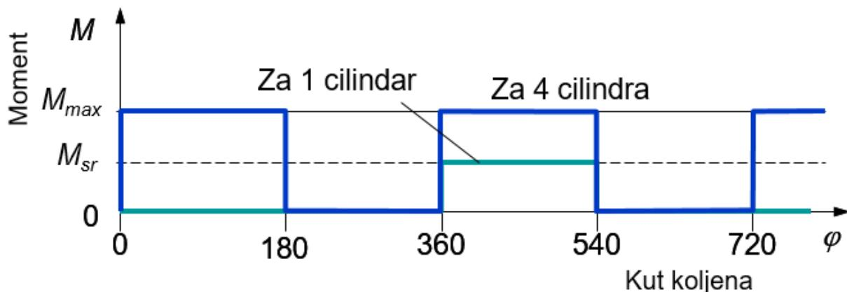
Slika 44. Moment za paljenje 2 cilindra istovremeno [3]
