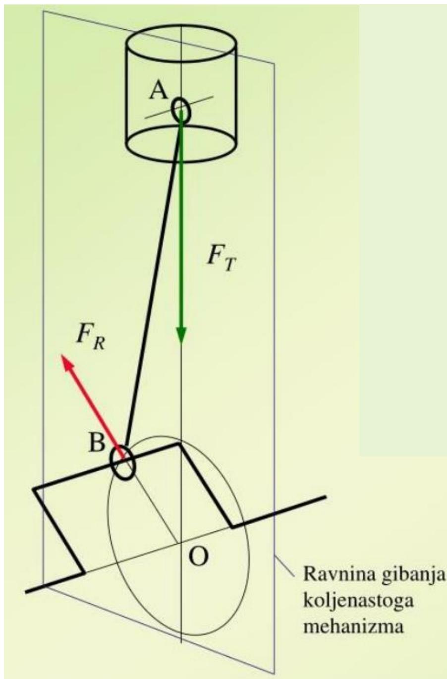
Slika 39. Inercijske sile u mehanizmu jednog cilindra [3]
