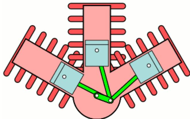
Slika 8. Presjek W konfiguracije trocilindarskog motora [8]
