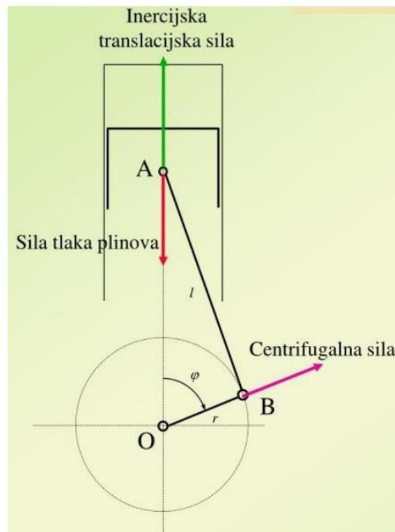
Slika 21. Sile u koljenastom mehanizmu za jedan cilindar [3]
