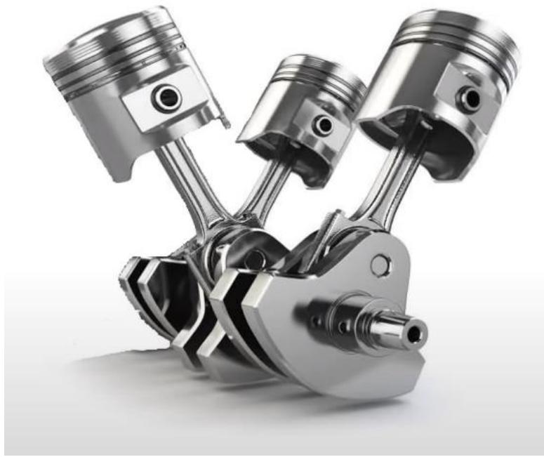
Slika 6. V konfiguracija trocilindarskog motora (V3) [8]
