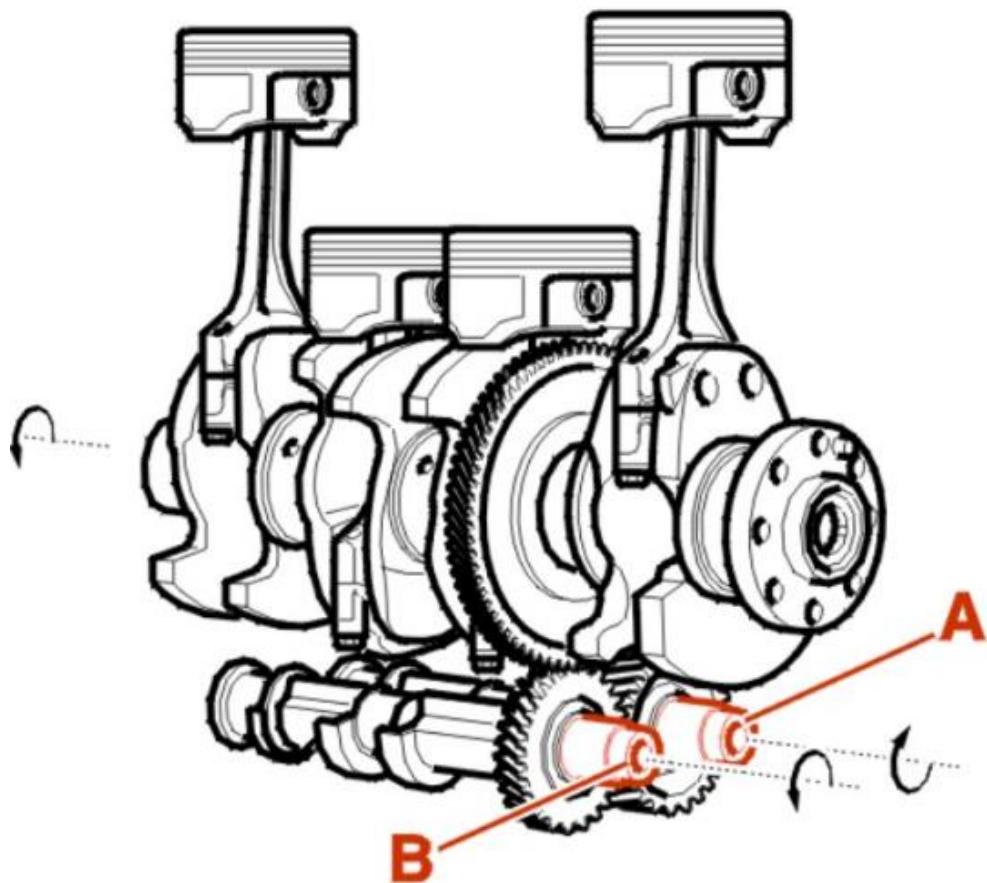
Slika 56. Rotirajuće osovine za poništavanje vibracija [6]
