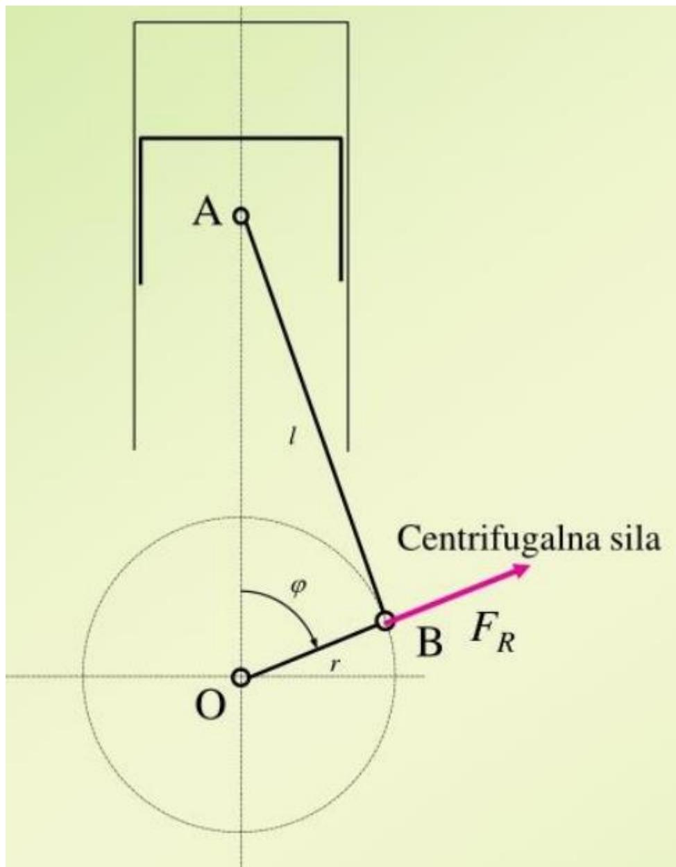
Slika 28. Centrifugalna sila na koljenastom vratilu [3]
