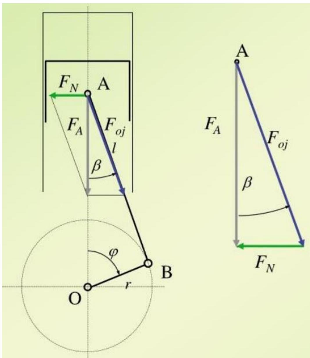
Slika 30. Rastavljanje sila u točki A klipnog mehanizma [3]
