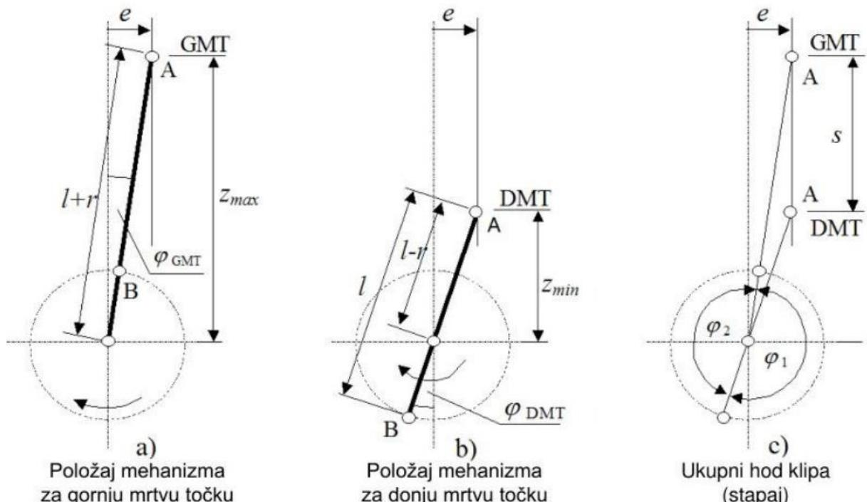
Slika 12. Krajnji položaj klipa kod decentriranog koljenastog mehanizma [3]
