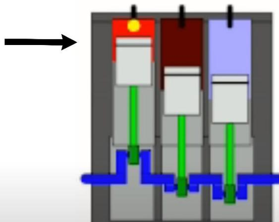
Slika 51. Rubni cilindar postiže gornju mrvu točku u rednom trocilindarskom motoru [8]
