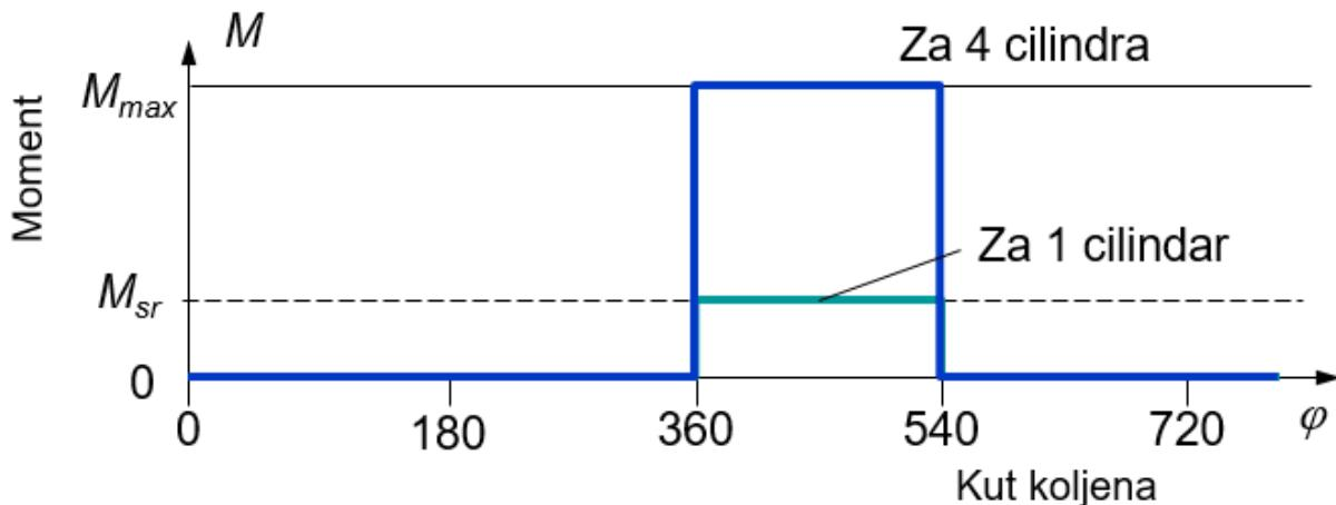
Slika 43. Moment za paljenje 4 cilindra istovremeno [3]
