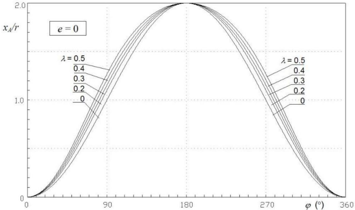
Slika 15. Hod klipa u ovisnostio omjeru polužja  $\lambda$  ( $e = 0$ ) [3]
