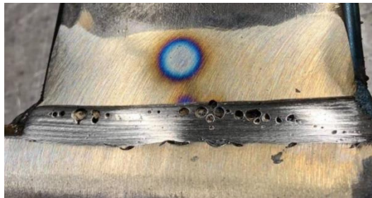
Sl. 3. „Pore“ u zavaru [4]
