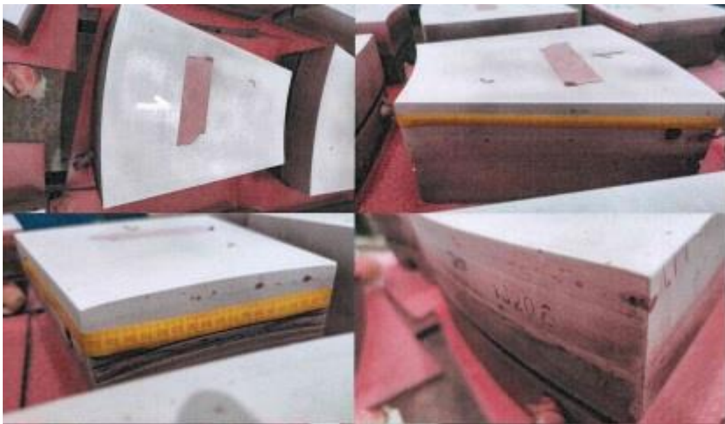
Slika 17: NDT test na nosećim segmentima
