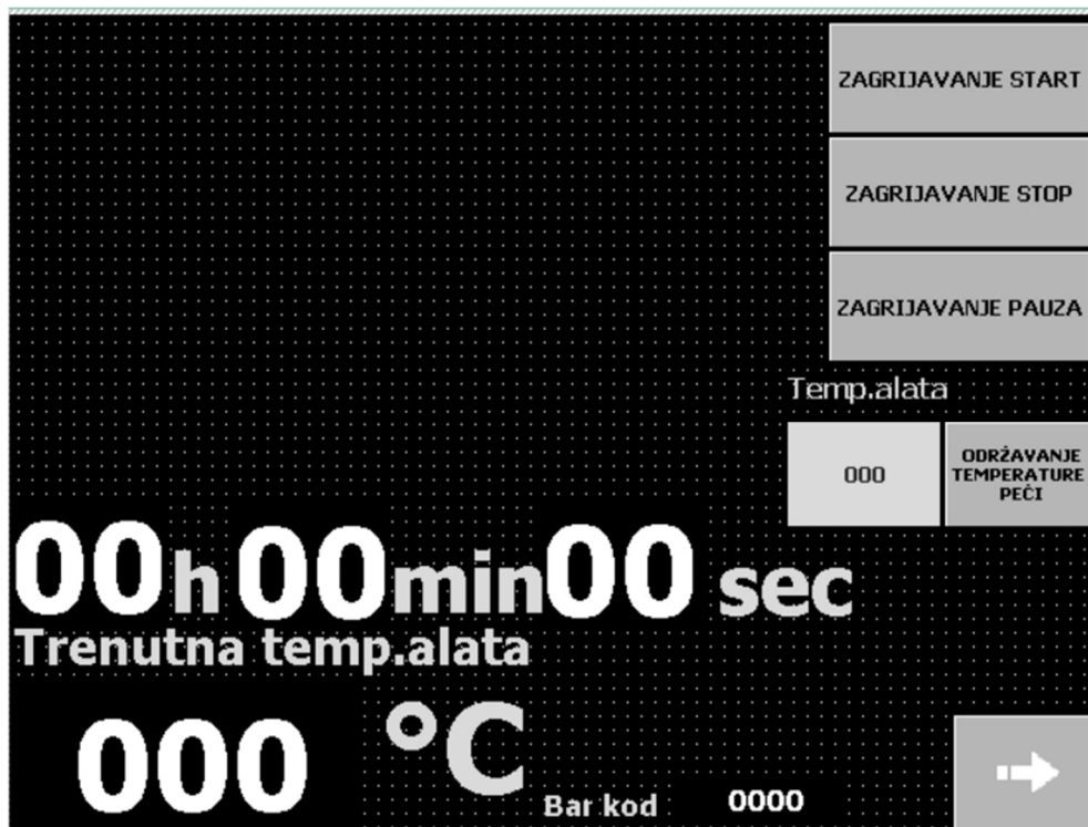
Slika 34. Automatsko upravljanje električne peći (izvorno autor)
