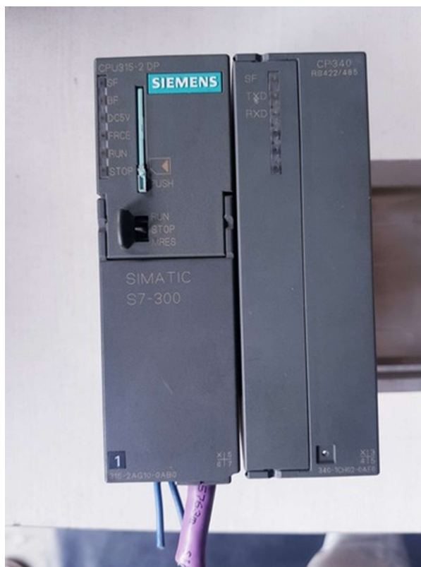
Slika 5. PLC Simatic s7-300 (izvorno autor)
