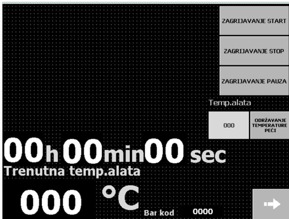
Slika 34. Automatsko upravljanje električne peći (izvorno autor)
