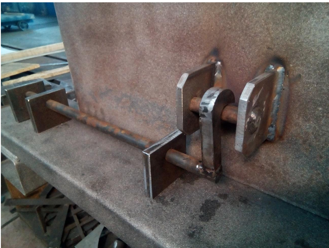
Slika 47. Zavarivanje mehanizma otključavanja, brave i nosača mehanizma
