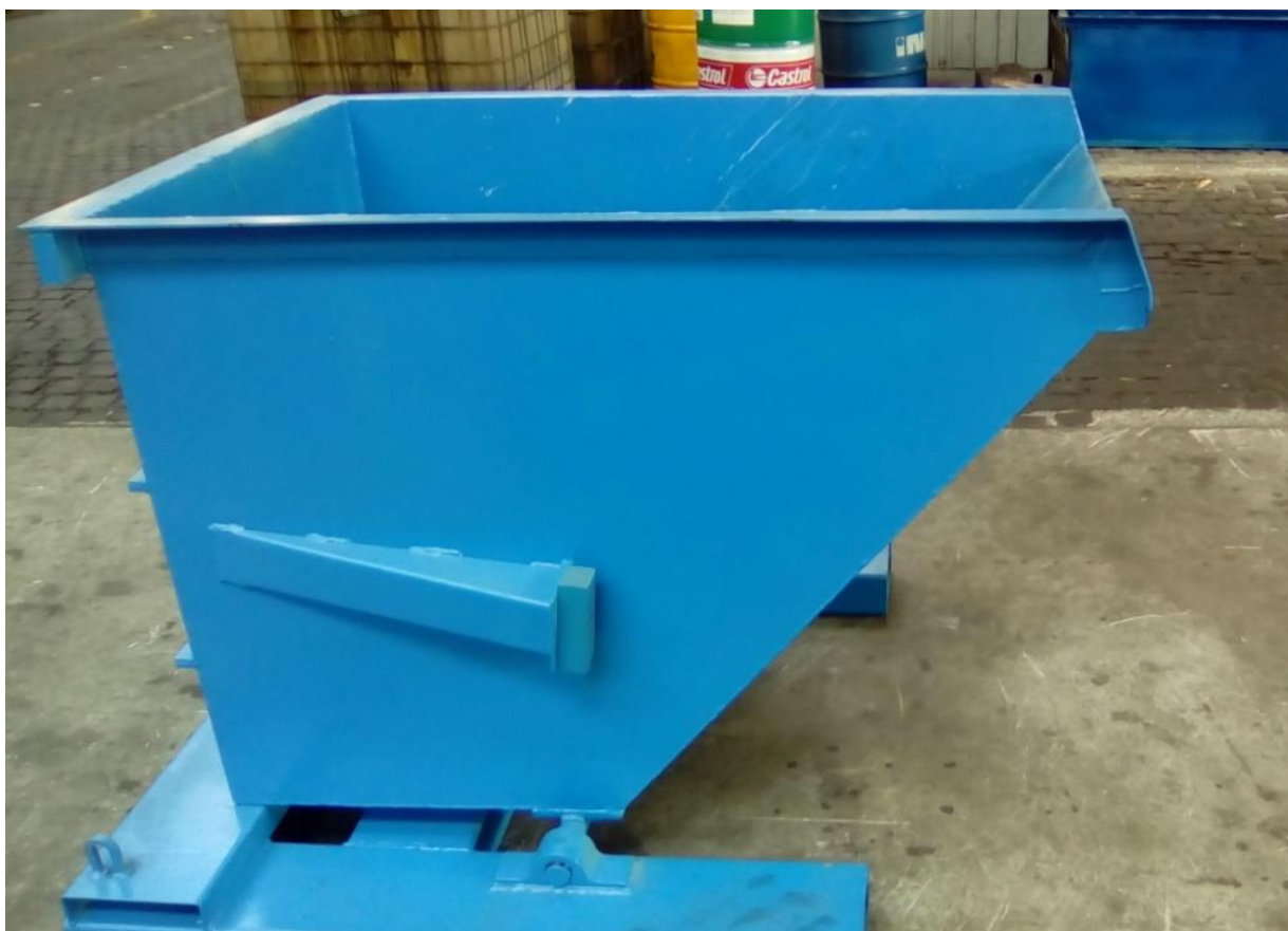
Slika 50. Samoistovarni kontejner poslije bojanja
