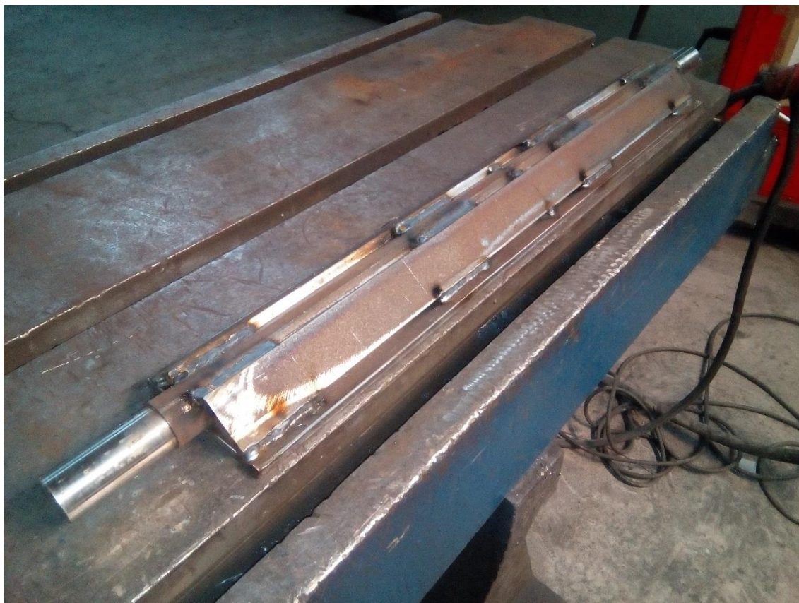
Slika 40. Ojačavanje osovine čeličnim profilima
