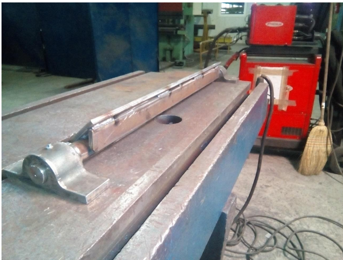
Slika 41. Sklapanje osovine i kućišta osovine
