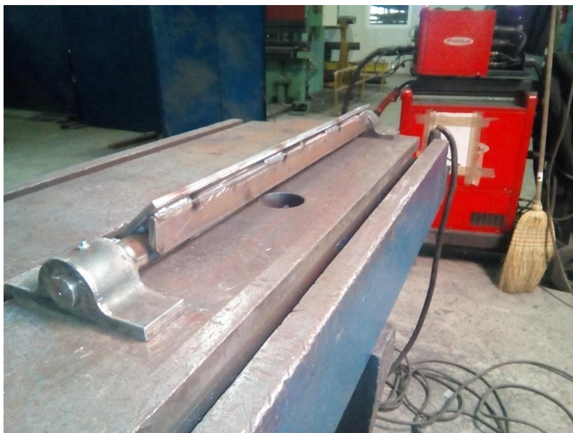
Slika 41. Sklapanje osovine i kućišta osovine
