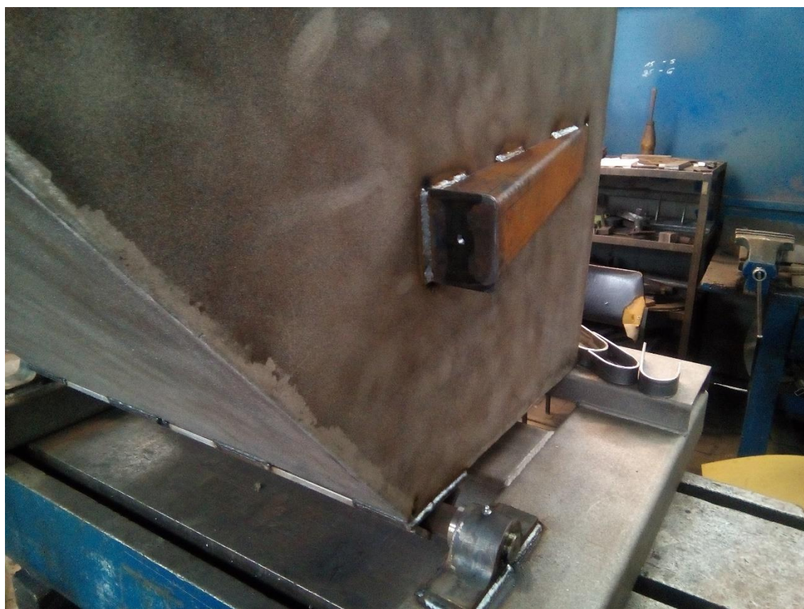
Slika 45. Zavarivanje bočnih odbojnika
