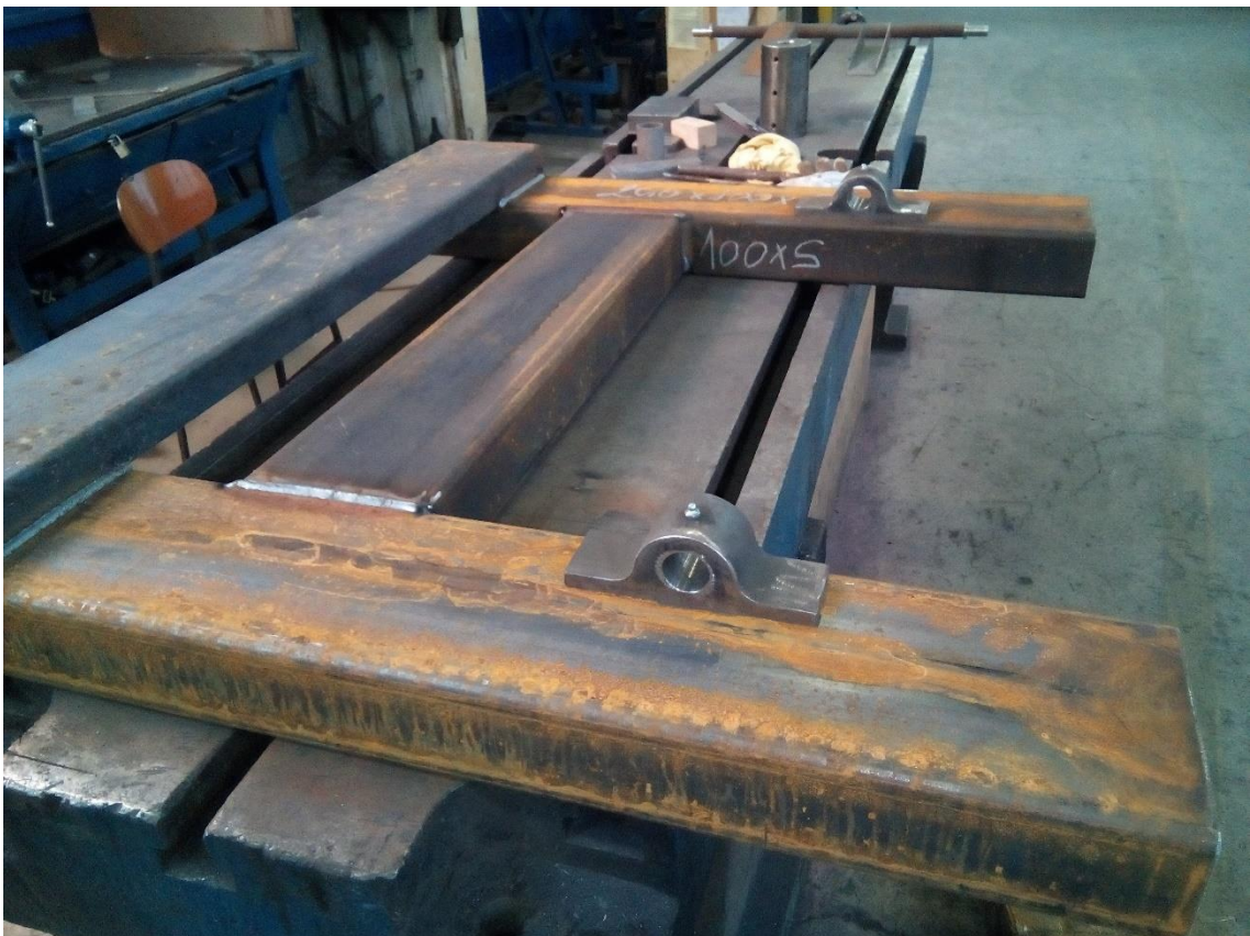
Slika 39. Postolje kontejnera u postupku izrade
