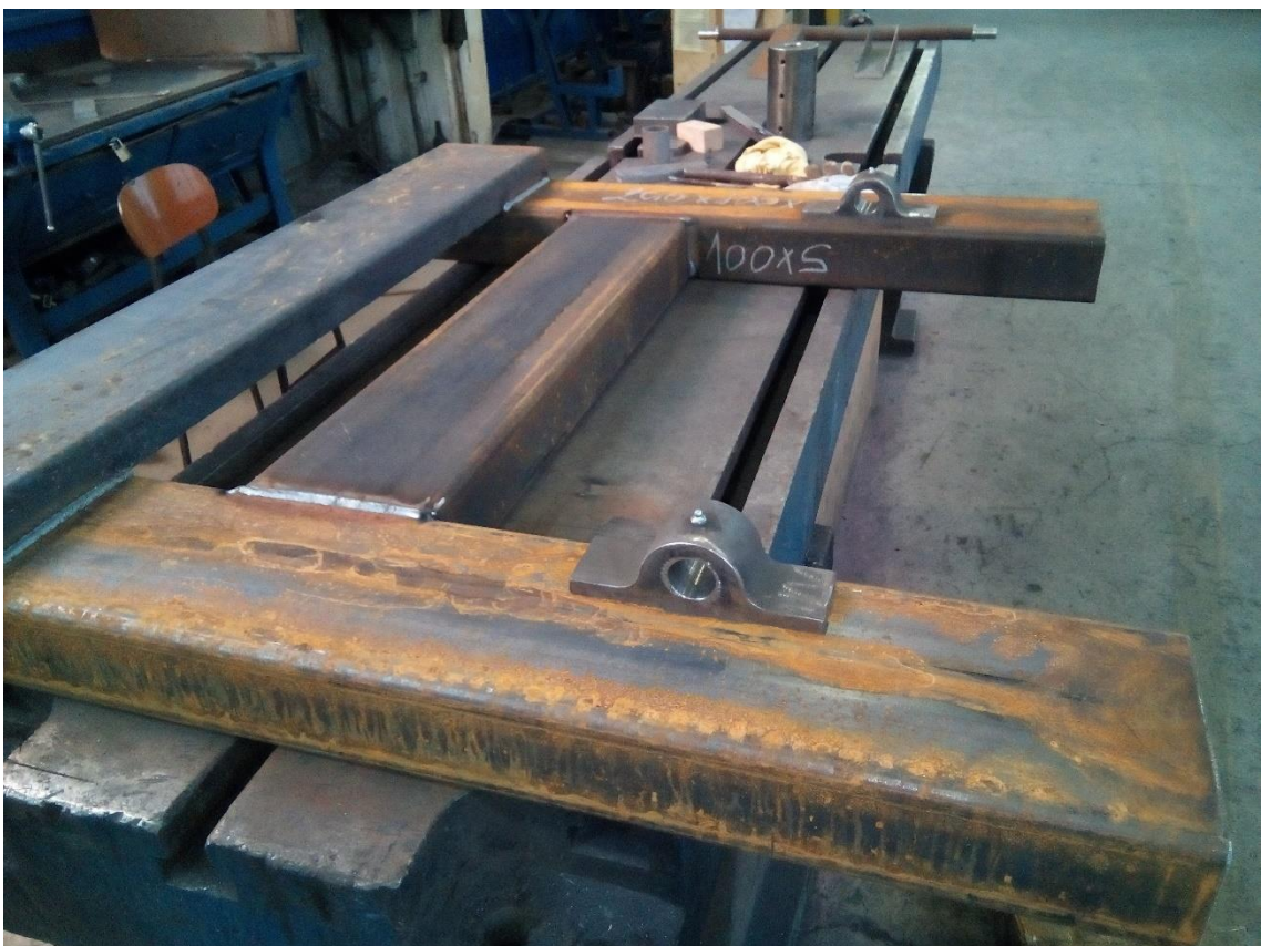
Slika 39. Postolje kontejnera u postupku izrade
