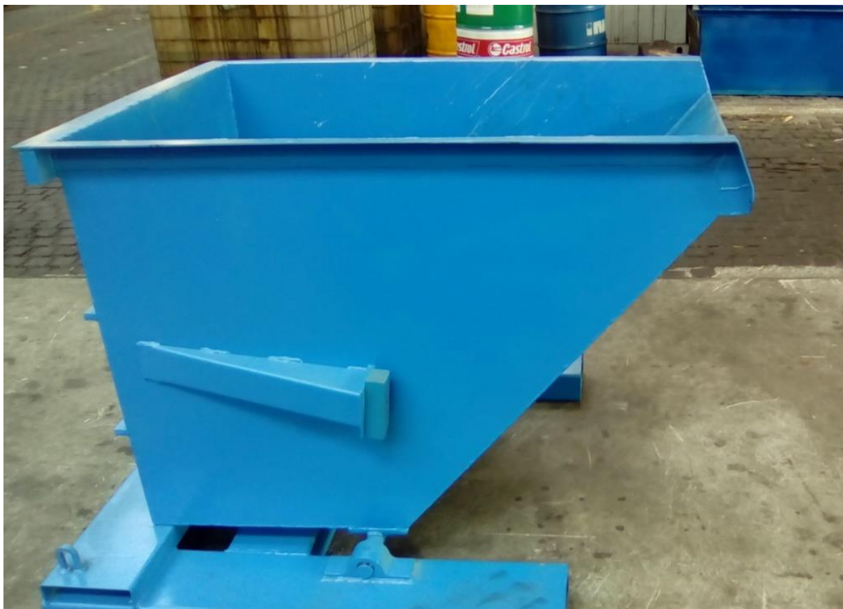
Slika 50. Samoistovarni kontejner poslije bojanja
