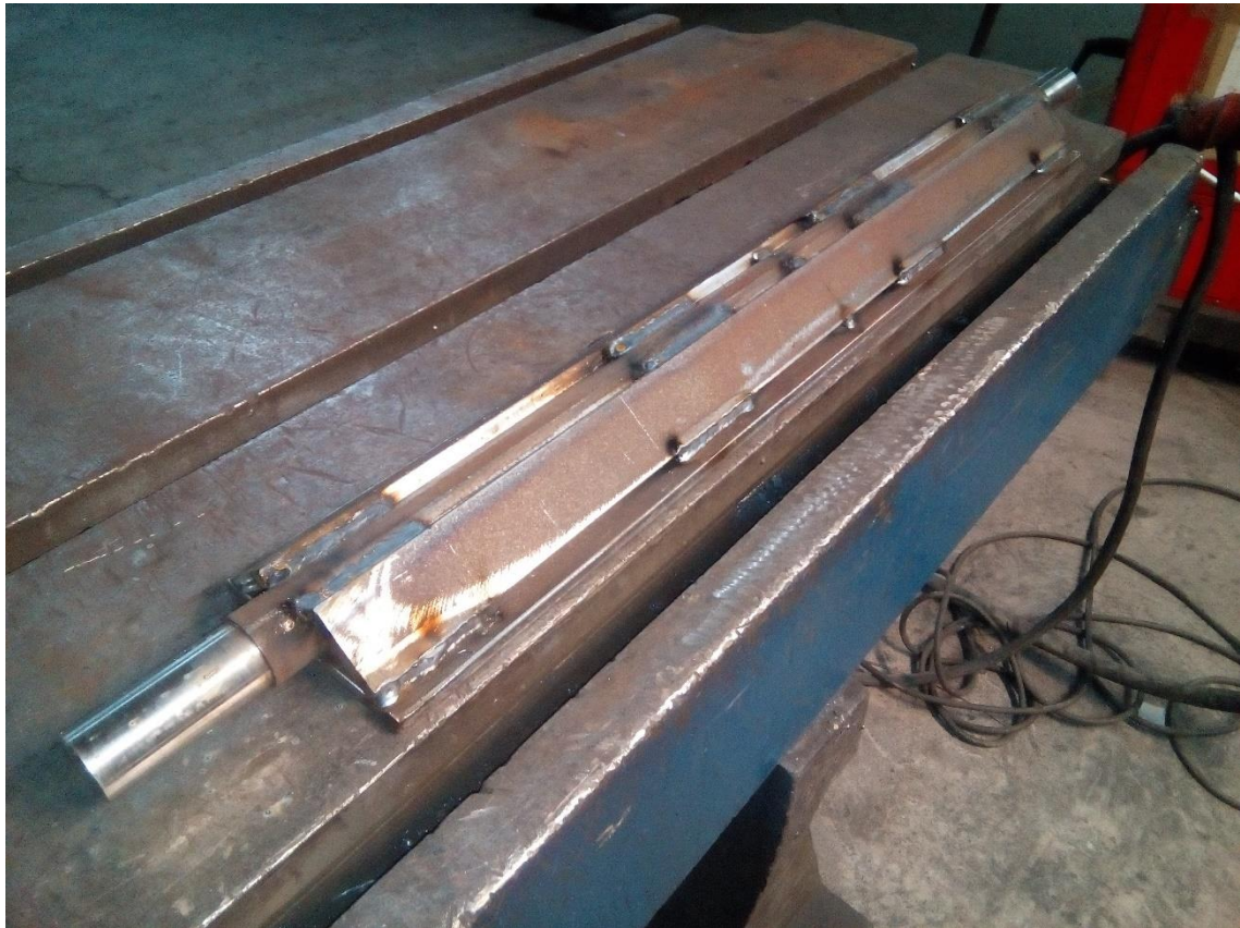
Slika 40. Ojačavanje osovine čeličnim profilima
