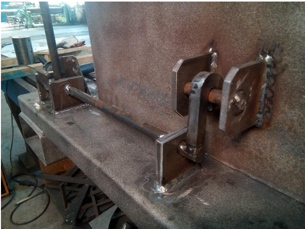
Slika 16. Mehanizam otključavanja kontejnera u procesu proizvodnje
