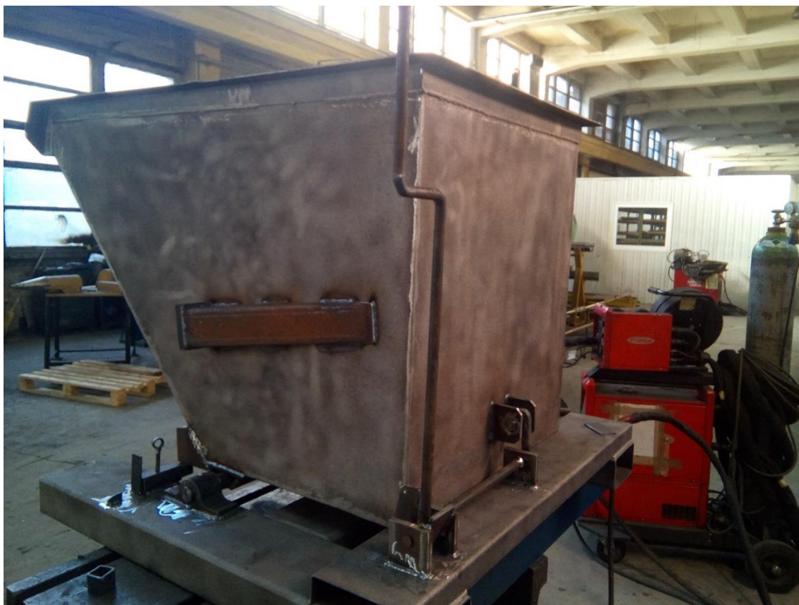
Slika 49. Gotovi proizvod prije bojanja
