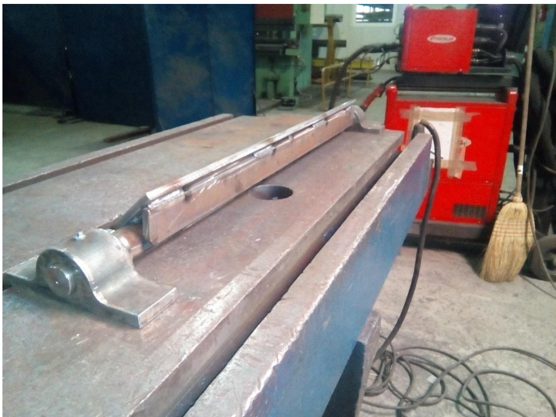
Slika 41. Sklapanje osovine i kućišta osovine
