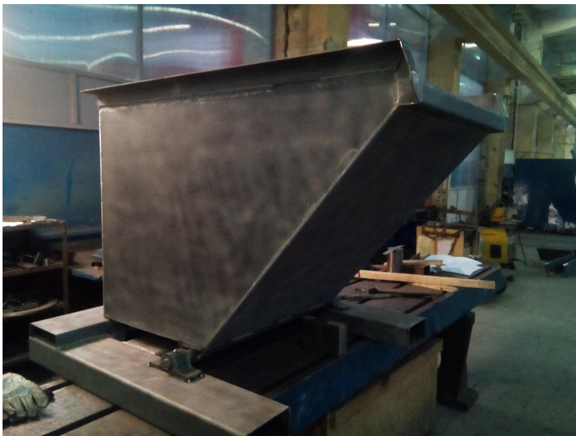
Slika 43. Zavarivanje kućišta osovine za postolje kontejnera
