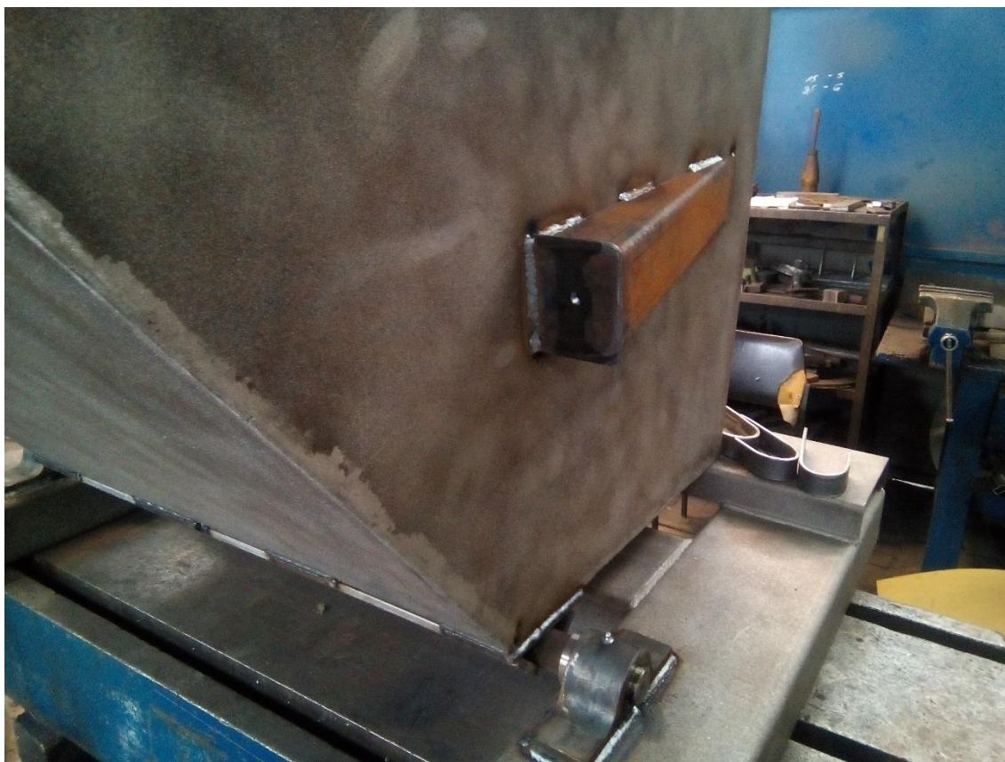
Slika 45. Zavarivanje bočnih odbojnika
