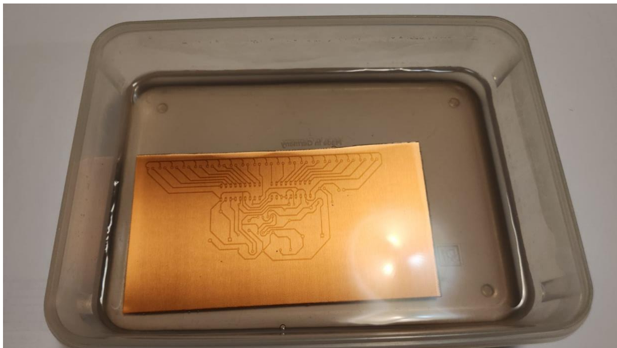
Slika 44. Postupno pojavljivanje obrisa usred kemijske reakcije
