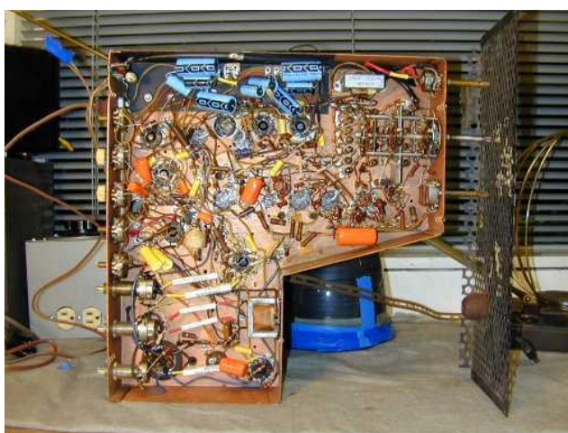
Slika 6. Stari Motorolin televizijski prijamnik s pretečom tiskane pločice [2]
