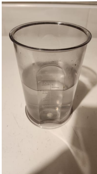
Slika 51. Natrijev persulfat nakon mješanja sa toplom vodom
