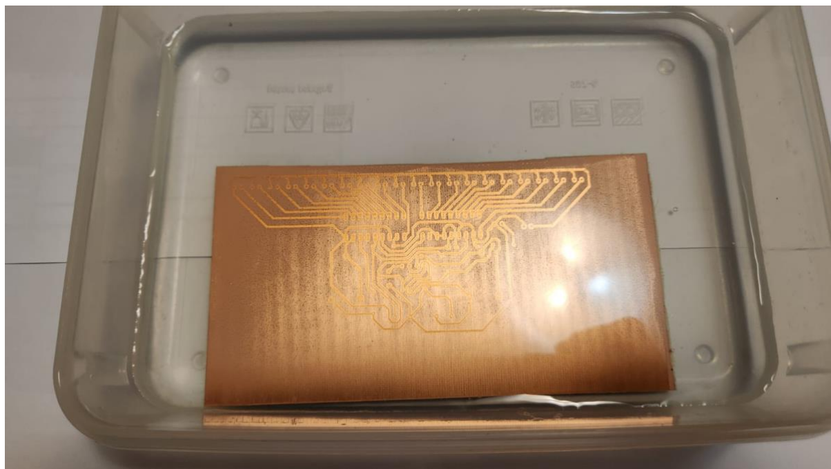
Slika 54. Tiskana pločica u tijeku postupka jetkanja
