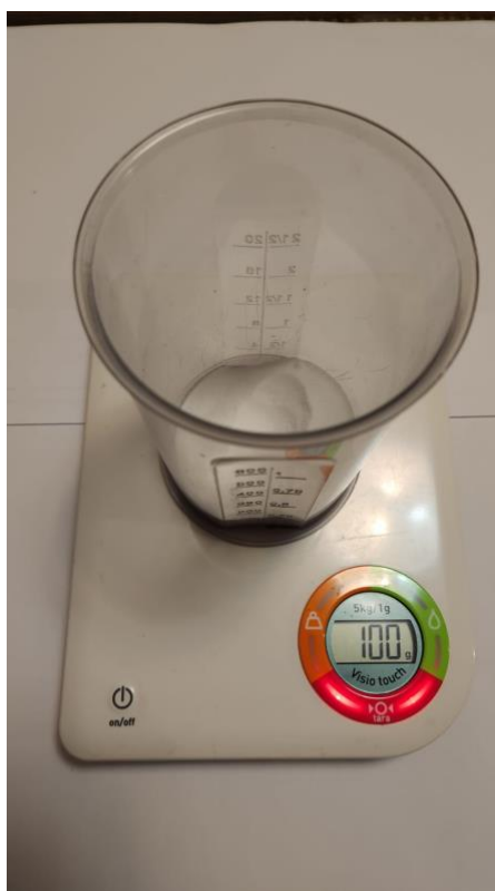
Slika 49. Točno određena doza natrijevog persulfate za 500 mL vode
