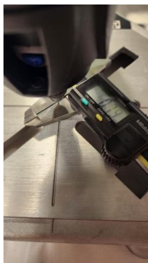
Slika 58. Promjer korištenog svrdla (0.8 mm)
