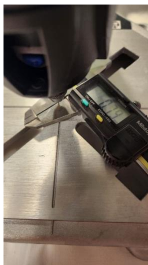
Slika 58. Promjer korištenog svrdla (0.8 mm)
