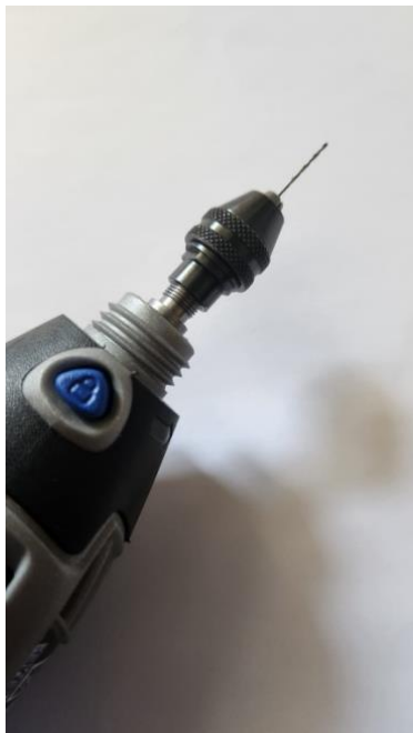
Slika 57. Svrdo montirano na specijaliziranoj bušilici
