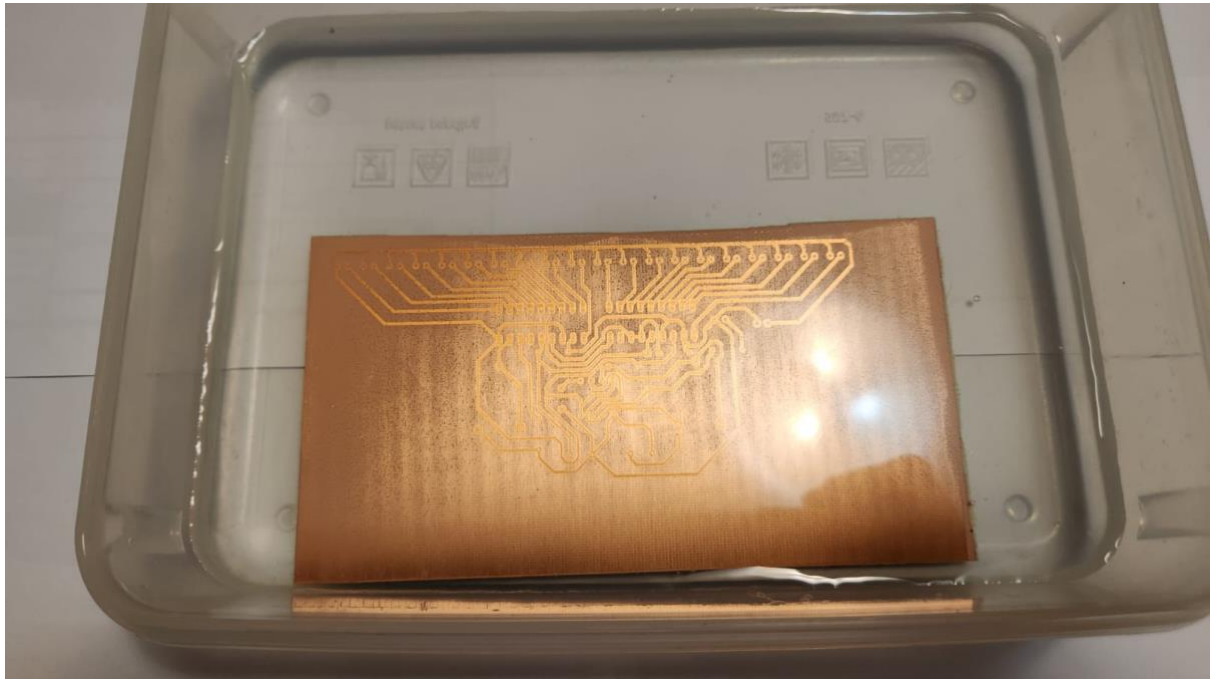
Slika 54. Tiskana pločica u tijeku postupka jetkanja
