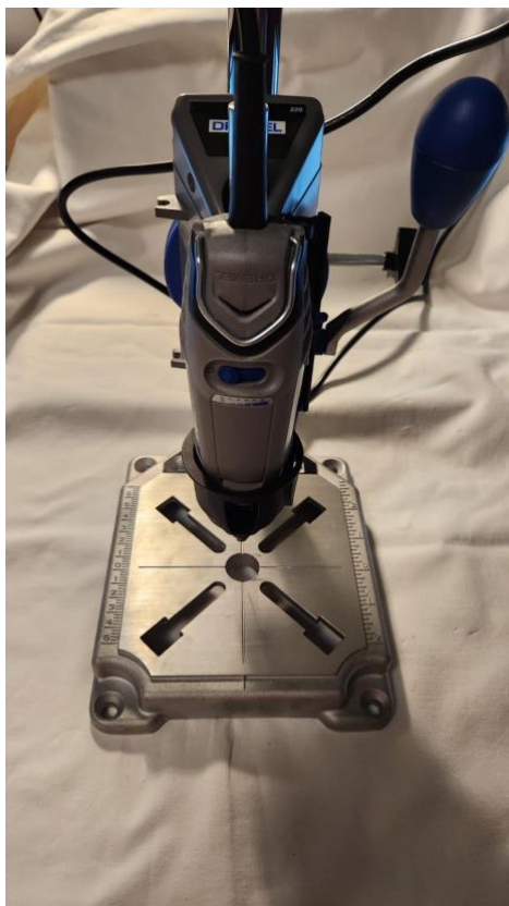
Slika 59. Specijalizirana bušilica sa stalkom za bušenje
