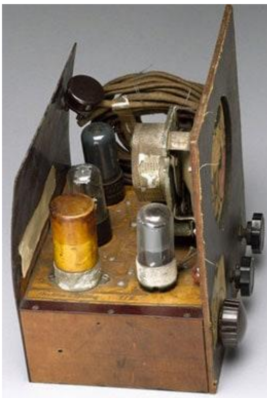
Slika 5. Radio Paula Eislera koji koristi prvu tiskanu pločicu (PCB) [2]
