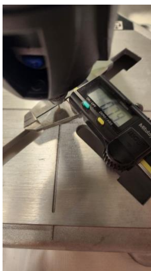
Slika 58. Promjer korištenog svrdla (0.8 mm)
