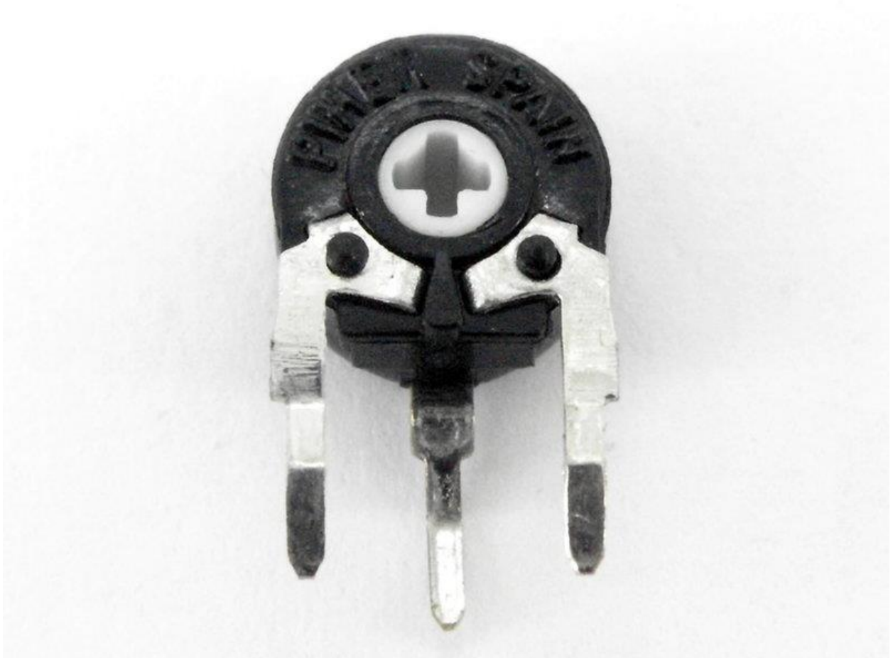
Slika 15. Otpornički trimer sa 3 nogice i vijkom za podešavanje [18]
