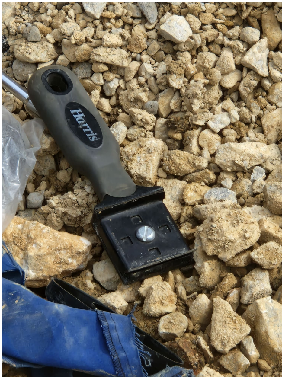
Slika 31. Alat za struganje oksidnog sloja sa cijevi [Izvorno autor]
