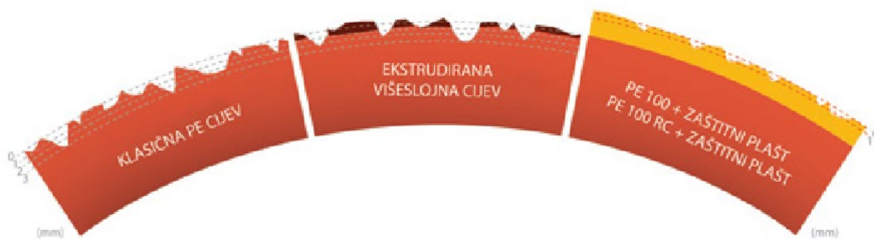
Slika 7. Debljina slojeva klasičnih, ekstrudiranih i cijevi za zaštitnim plaštom [8]
