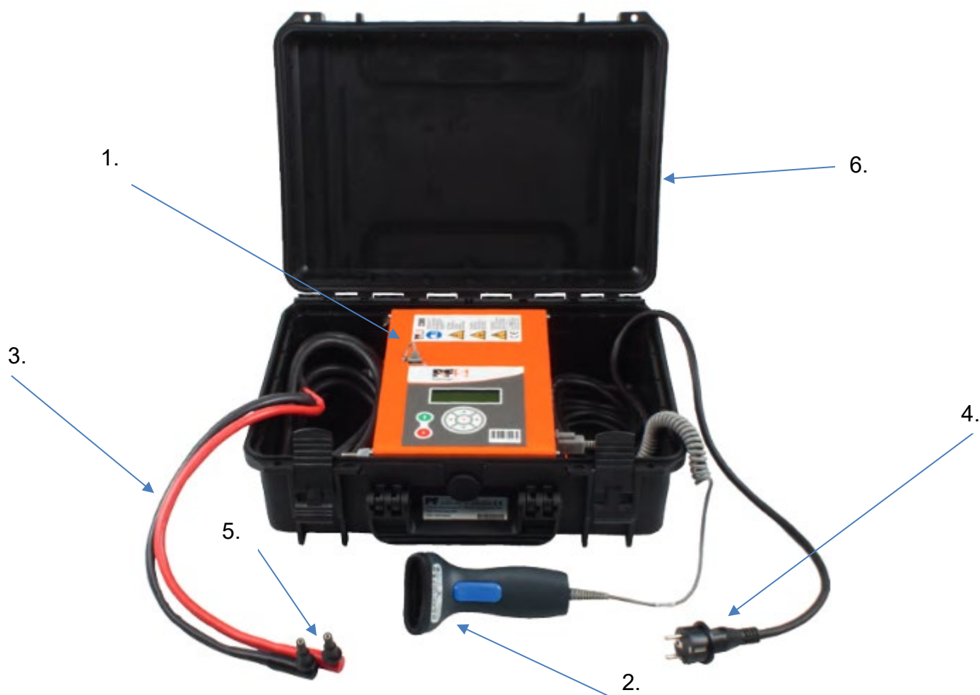
Slika 19. Oprema za elektrofuzijsko zavarivanje [16]
