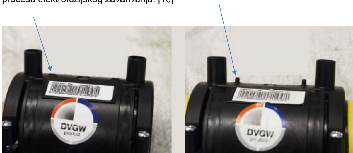
Slika 10. Prikaz indikatora EF zavarivanja prije i poslije procesa [11]
