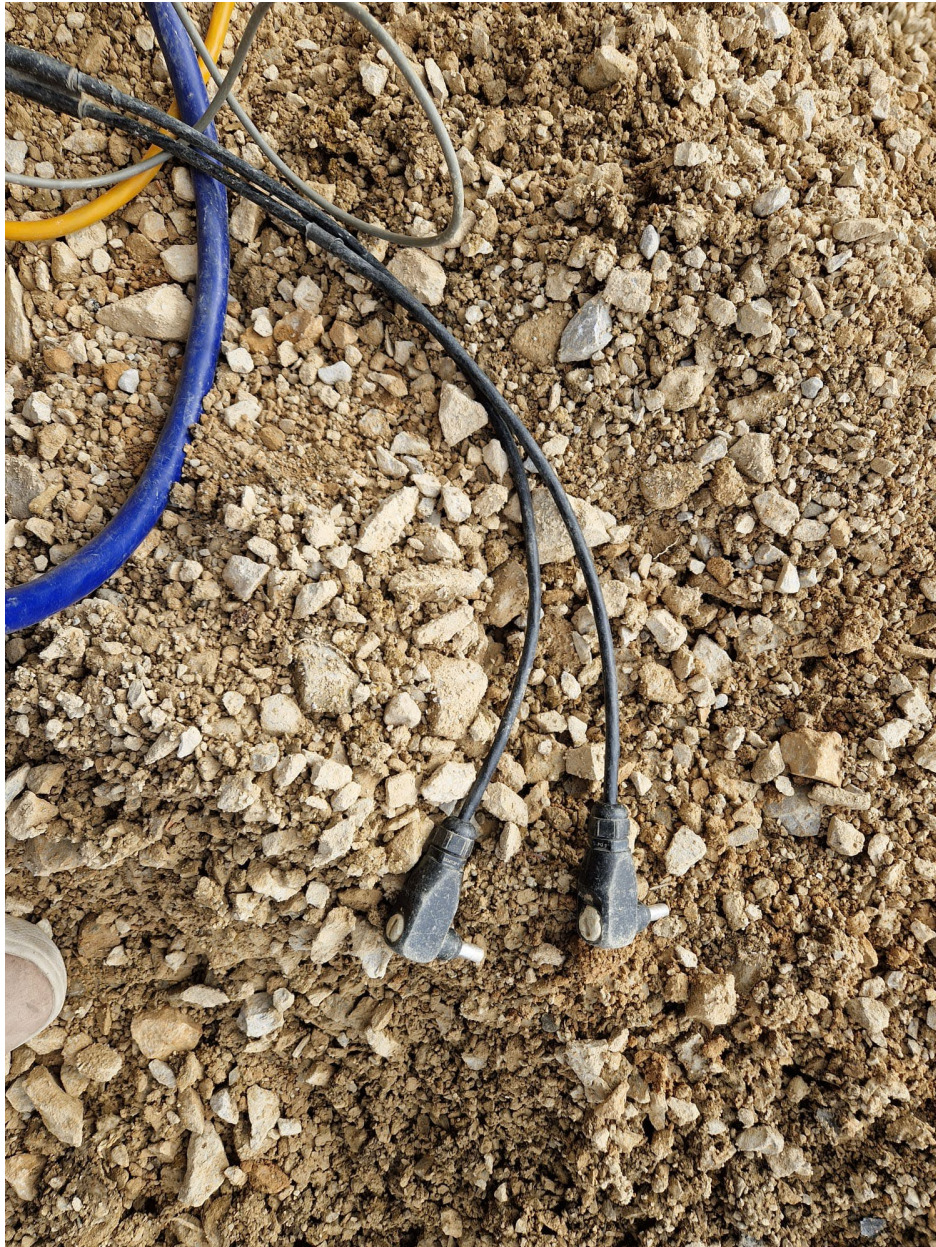
Slika 29. Kabeli i pinovi za elektrofuzijsko zavarivanje [Izvorno autor]
