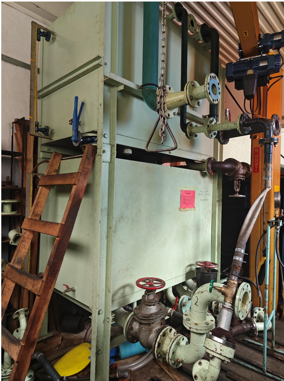
Slika 36 Volumetrička posuda za ispitivanje pumpi [izvor: autor]
