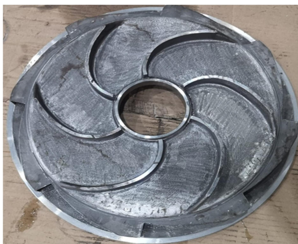
Slika 2 Stator sa lopaticama [3]
