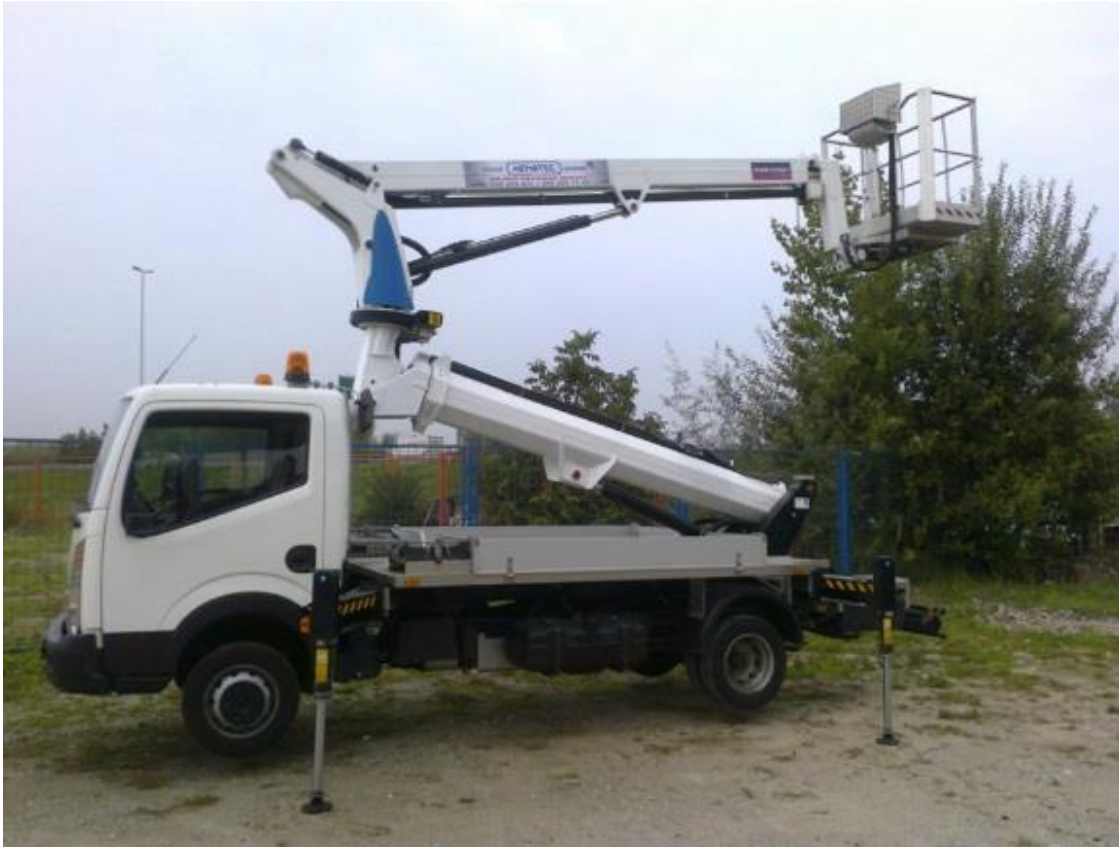
Slika 30: Vozilo s teleskopskom radnom platformom [ https://hematec.hr/proizvod/kamion-s-kosarom-cte-mp20-13/ ]
