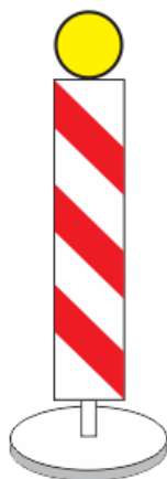
Slika 9: Ploče za obilježavanje mjesta izvođenja radova na cesti ili oštećenja kolnika s treptačem
