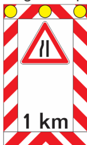
Slika 10: Signalna ploča za označavanje mjesta suženja kolnika
