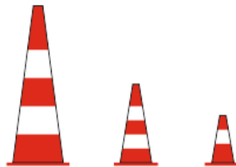
Slika 7: Stožac obilježava mjesta kratkotrajnih radova na cesti K13
