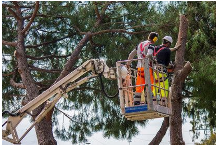
Slika 33: Korištenje hidrauličke košare za rezanje drveća [ https:// www.rusenjedrveca.com ]
