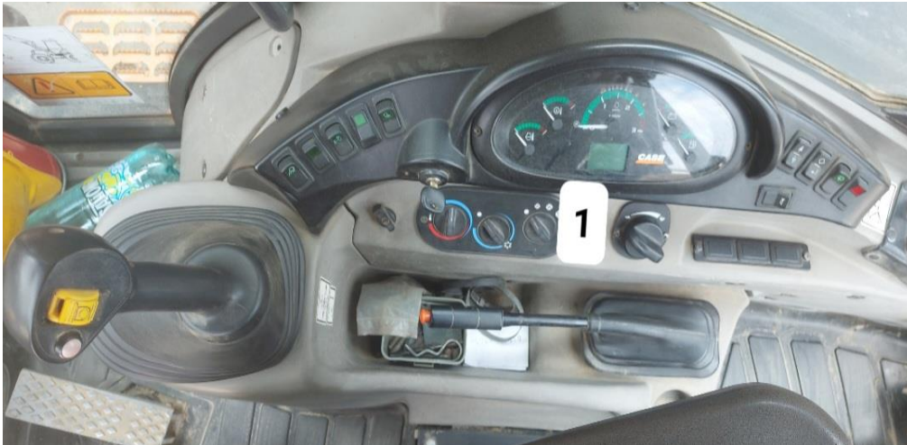
Slika 13. Prekidači za upravljanje prednjom i zadnjom korpom
