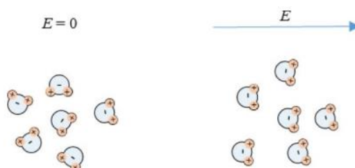
Slika 2.3.4. Prikaz orijentacijske polarizacije polariziranih molekula
