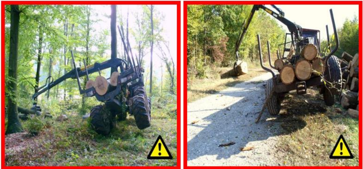
Slika 12. Dizanje kotača od tla prilikom utovara [13]
