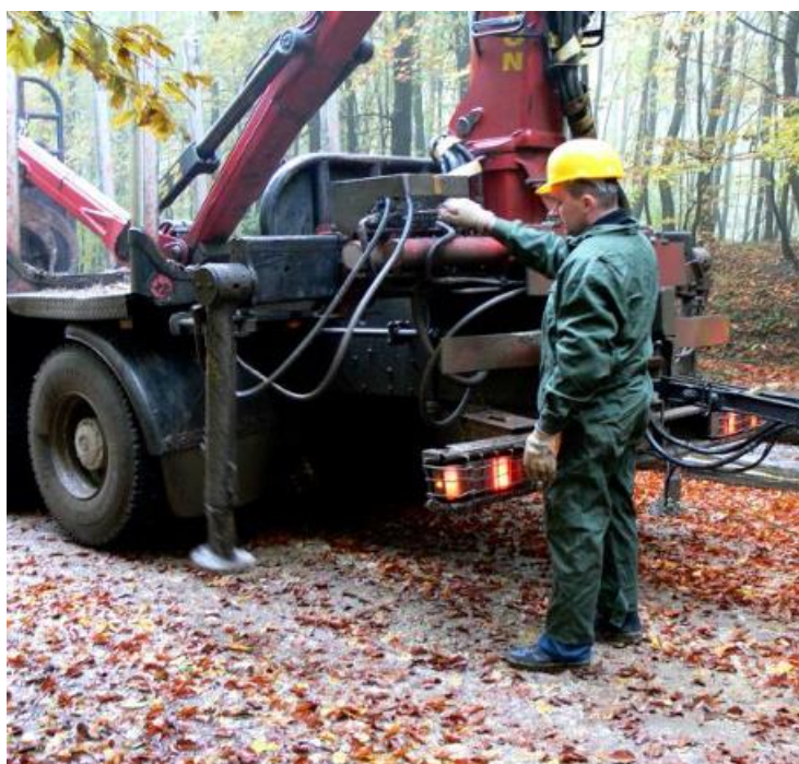
Slika 10. Položaj rukovatelja dizalicom prilikom spuštanja stabilizatora [13]
