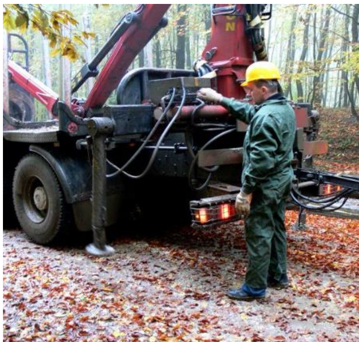
Slika 10. Položaj rukovatelja dizalicom prilikom spuštanja stabilizatora [13]
