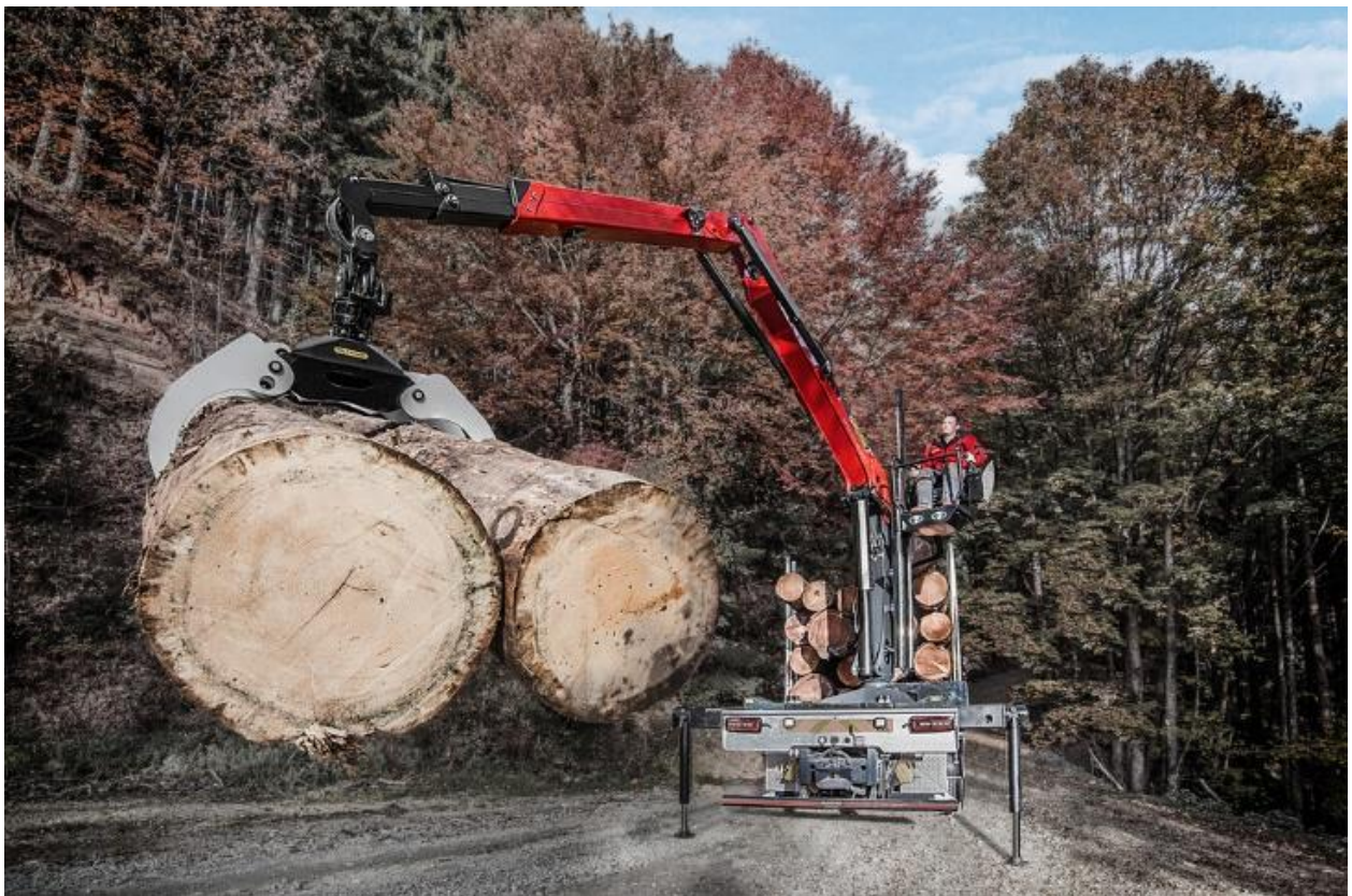
Slika 6. Prikaz utovara i primjer pravilno postavljenih stabilizatora koji sprječavaju prevrtanje ili naginjanje vozila. [5]
