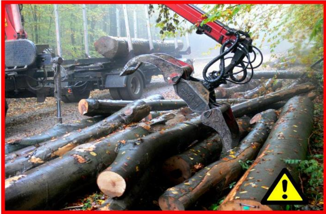
Slika 16. Izvlačenje sortimenta iz hrpe [13]
