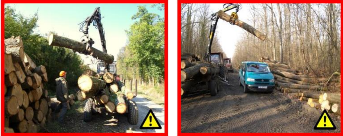
Slika 11. Radnik i vozilo u radnom prostoru dizalice, strogo zabranjeno! [13]
