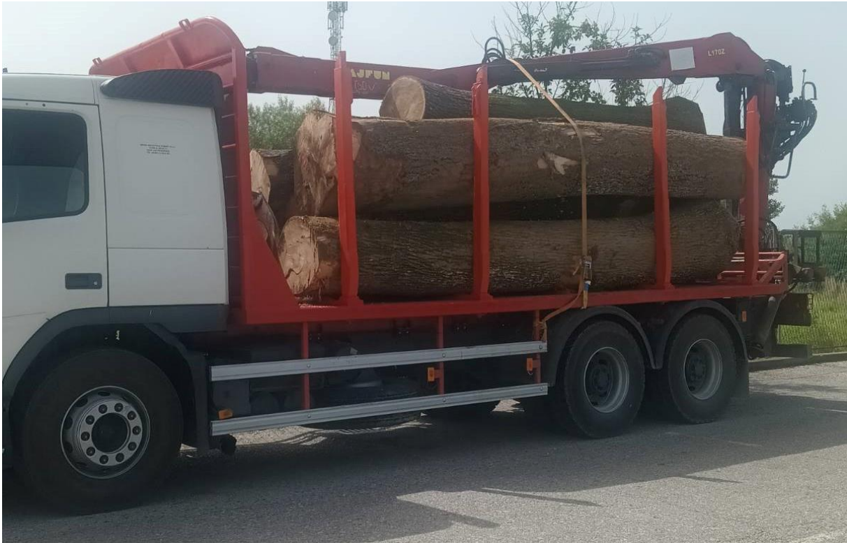
Slika 18. Dizalica u transportnom položaju [14]
