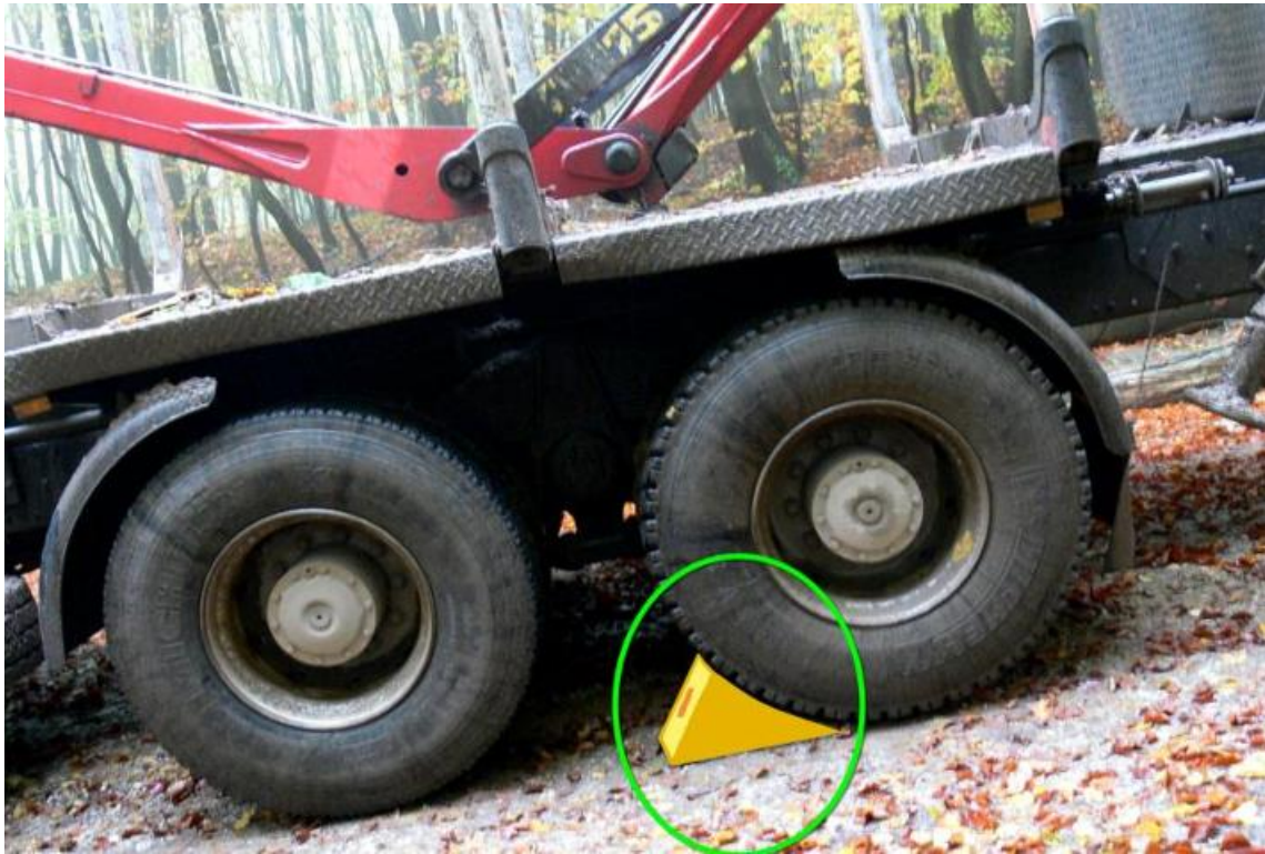
Slika 8. Osiguranje vozila na nizbrdici [13]
