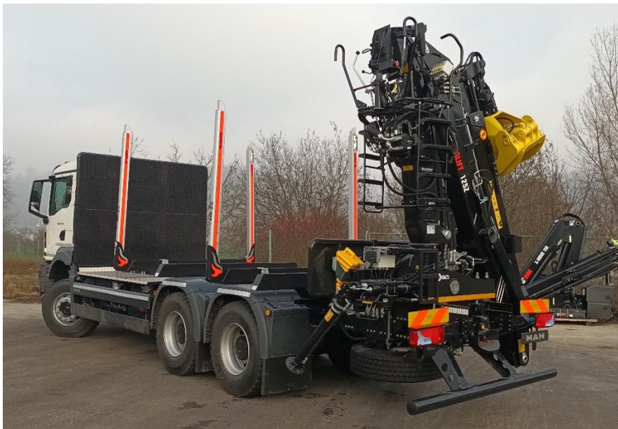
Slika 4. Primjer kamiona sa šumarskom nadogradnjom i dizalicom [3]
