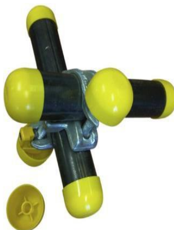
Slika 10. Pravilan način označavanja stršaka skele
