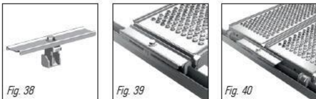
Slika 9. a, b, c Pravilan način učvršćenja radnog poda skele
