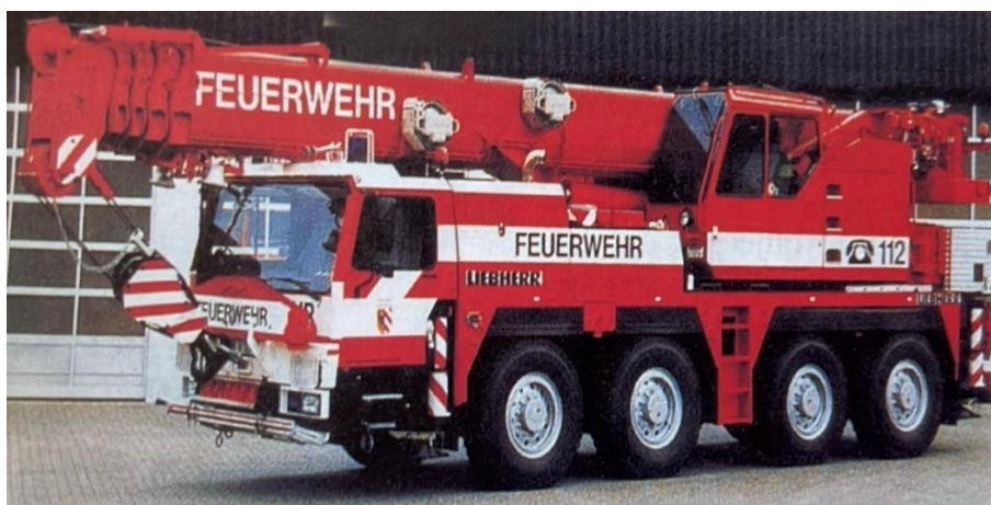
Slika 13. Tehničko vozilo – dizalica [7]
