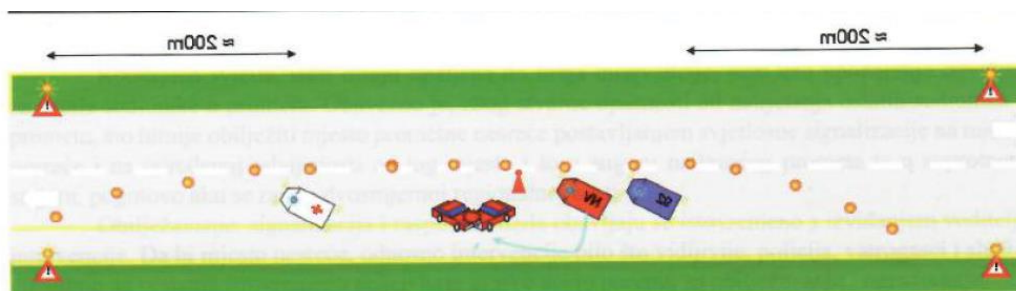
Slika 5. Razmještaj vozila i signalizacije na dvosmjernoj cesti [8]
