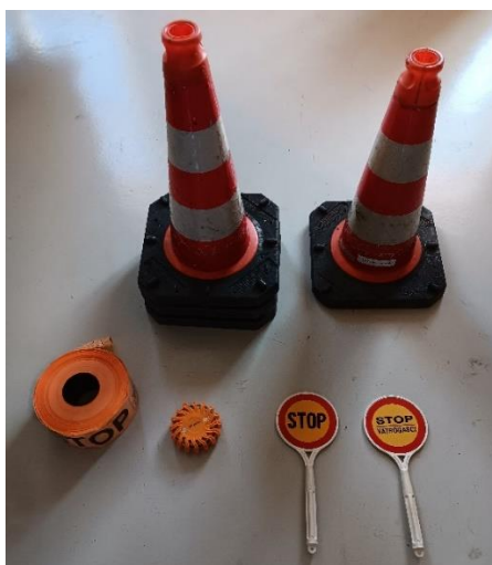
Slika 4. Oprema za obilježavanje i signaliziranje mjesta nesreće [4]
