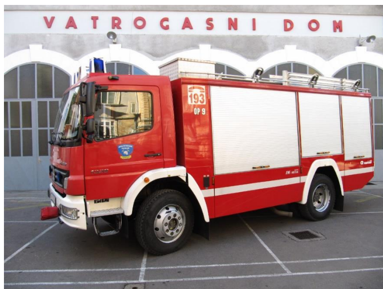
Slika 11. Srednje teško tehničko vozilo (TV-2) [9]
