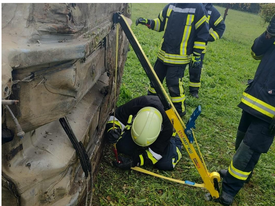
Slika 20. Primjena Stabfast sustava [11]
