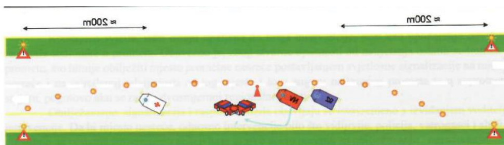
Slika 5. Razmještaj vozila i signalizacije na dvosmjernoj cesti [8]
