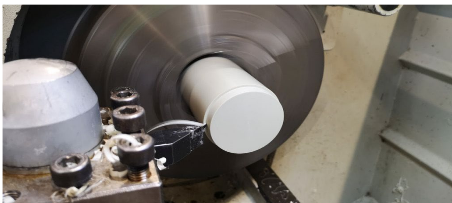
Slika 11 Prikaz tokarenja polimernog materijala[12]
