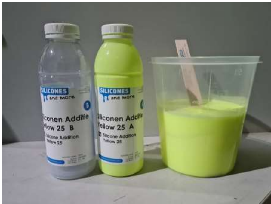
Slika 21 Komponente za silikonski kalup
