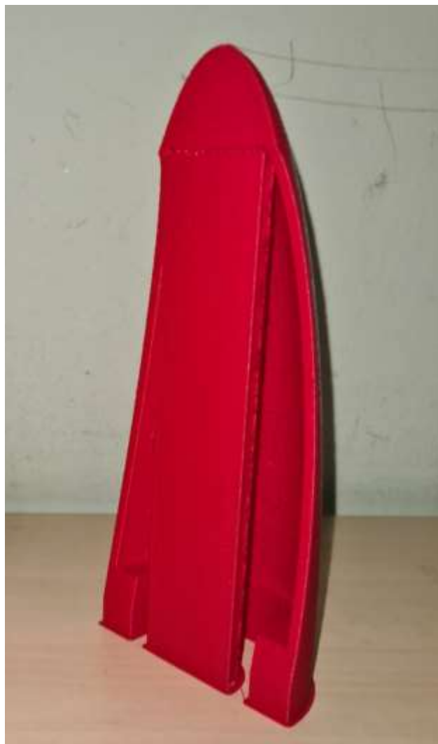
Slika 15 Model sa suport materijalom
