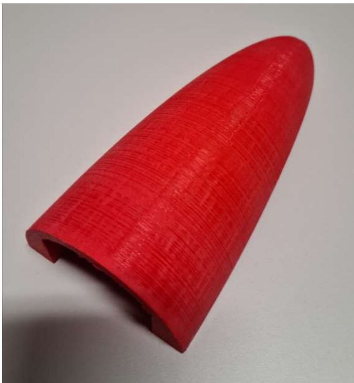
Slika 16 Model nakon obrade brusnim papirom
