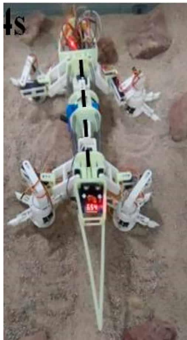
Slika 9. Biomimetički model gušter robota [8]
