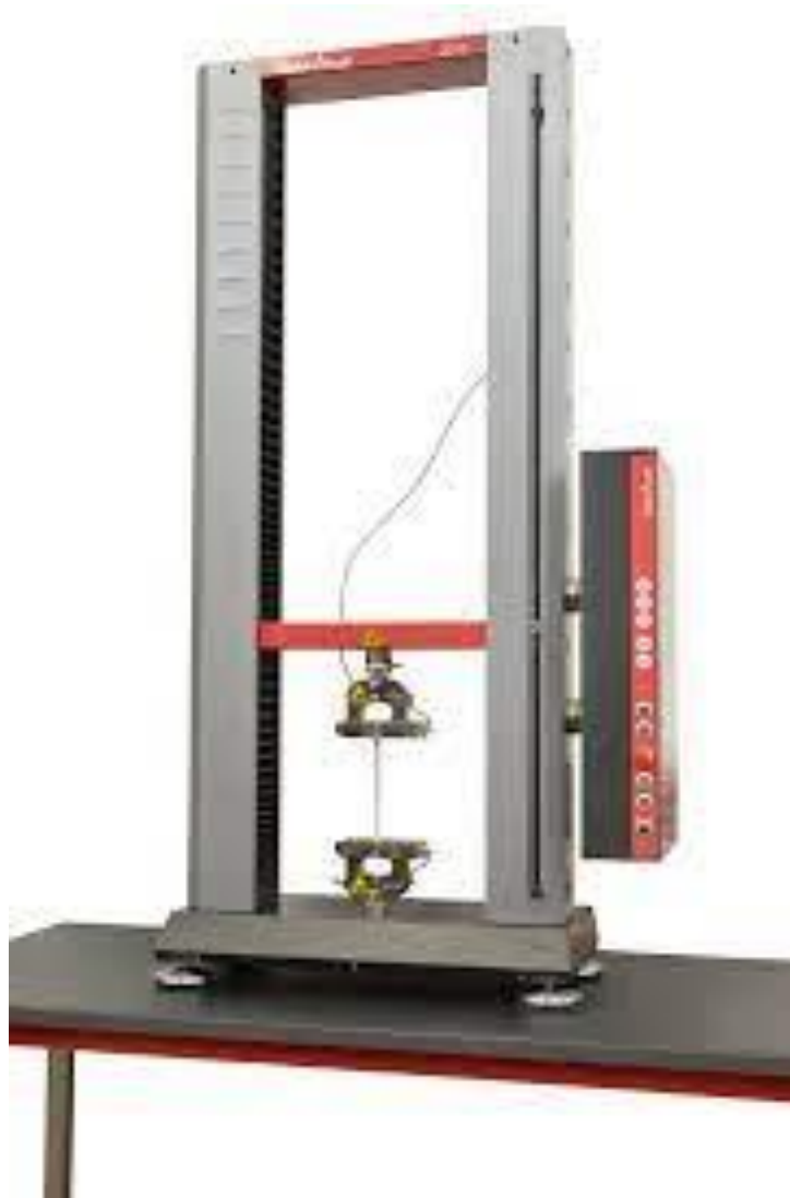
Slika 19. Uređaj Zwick/Roell Z005 [9]
