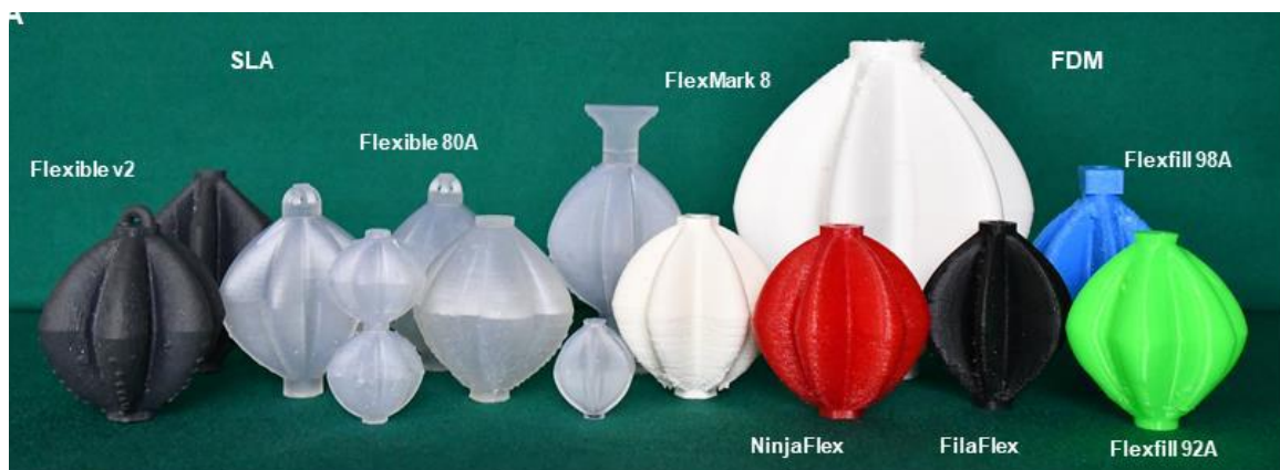
Slika 16. Modeli GRACE-a izrađeni različitim tehnologijama [9]
