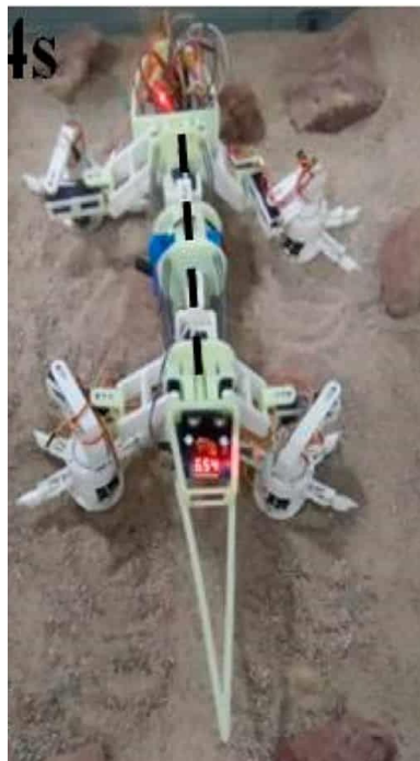
Slika 9. Biomimetički model gušter robota [8]
