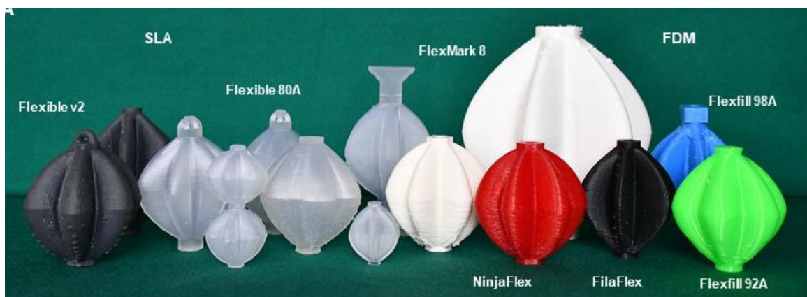
Slika 16. Modeli GRACE-a izrađeni različitim tehnologijama [9]
