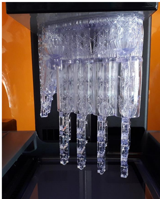
Slika 24. Printanje robotske šake [9]
