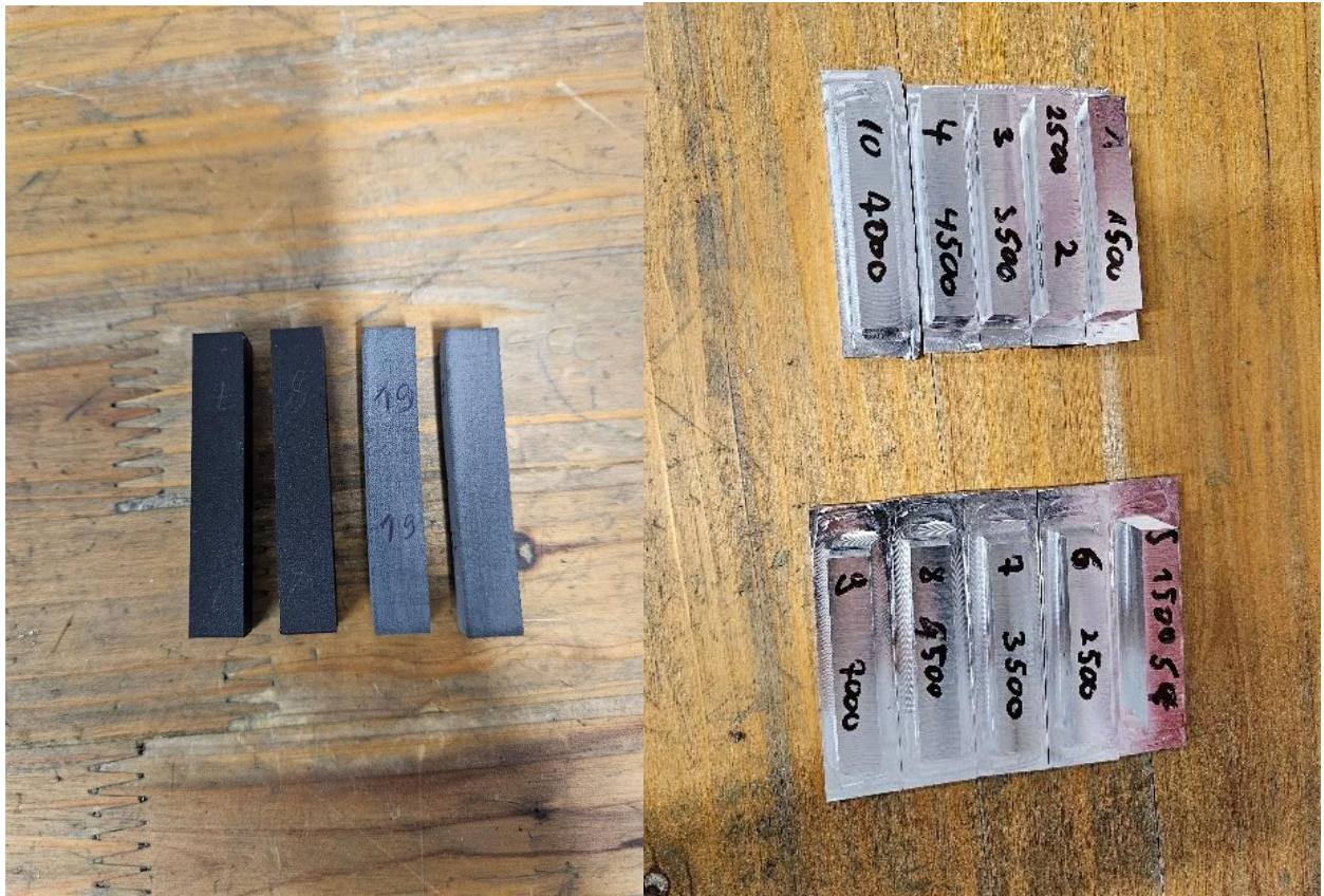
Slika 39. Uzorci dobiveni SLS postupkom i uzorci izrađeni strojnom obradom aluminija
