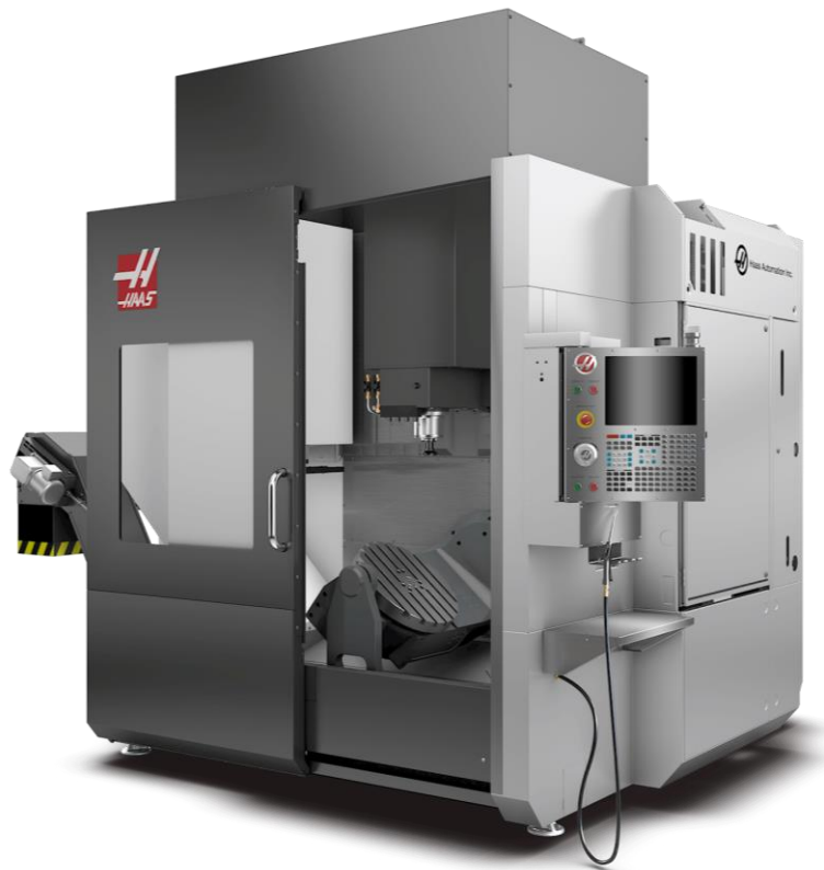
Slika 15. 5D obradni centar [11]
