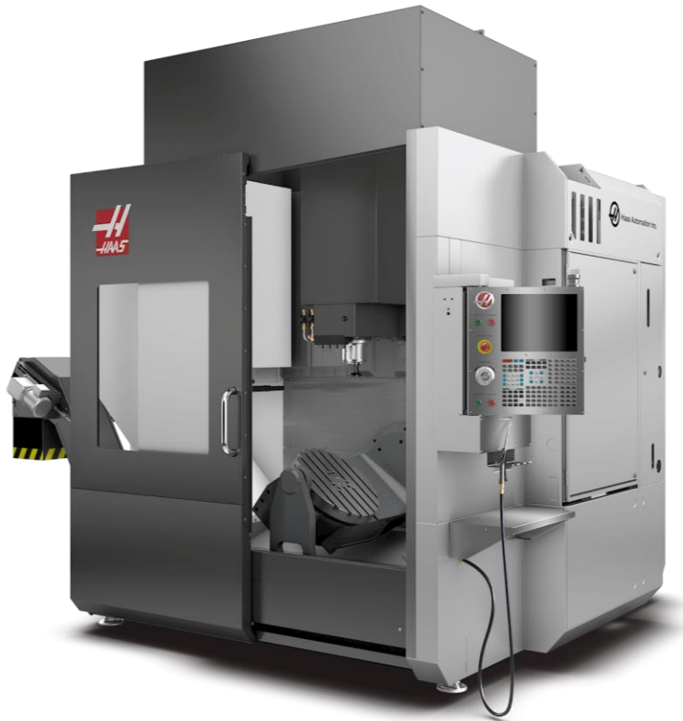
Slika 15. 5D obradni centar [11]
