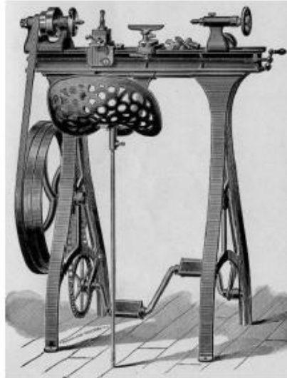
Slika 2. Prvi praktični industrijski tokarski stroj [4]
