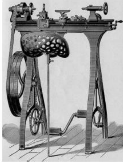
Slika 2. Prvi praktični industrijski tokarski stroj [4]
