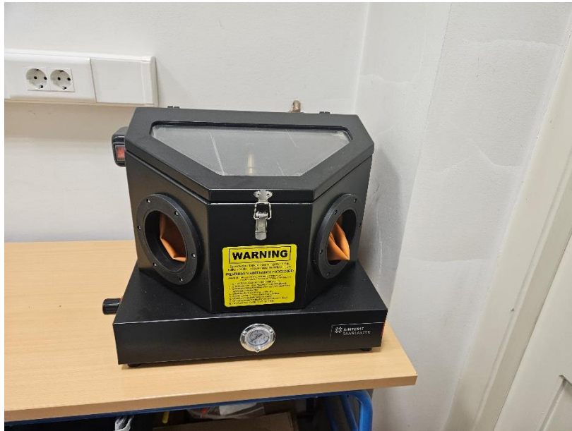
Slika 36. Pjeskarilica za naknadnu obradu uzoraka dobivenih SLS aditivnom tehnologijom Sinterit sandblaster
