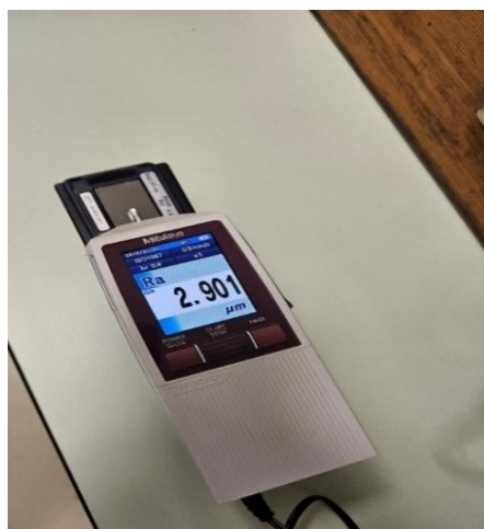
Slika 37. Uređaj za mjerenje hrapavosti Mitutoyo Surftest SJ-210
