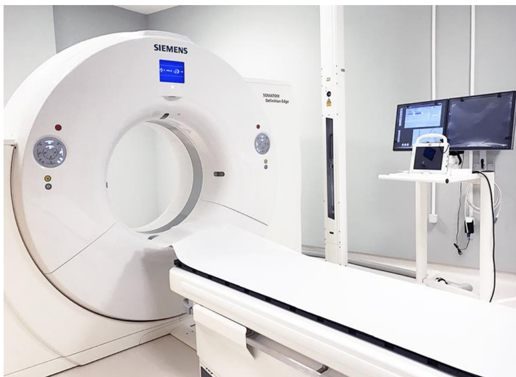
Slika 7: Rendgenski uređaj za računalnu tomografiju (CT)
