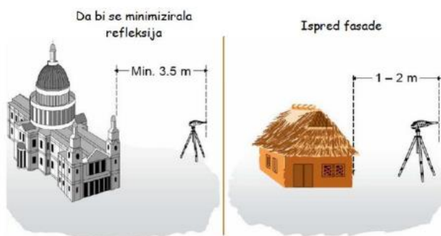
Slika 9: Mjerenje buke na vanjskom prostoru [6]
