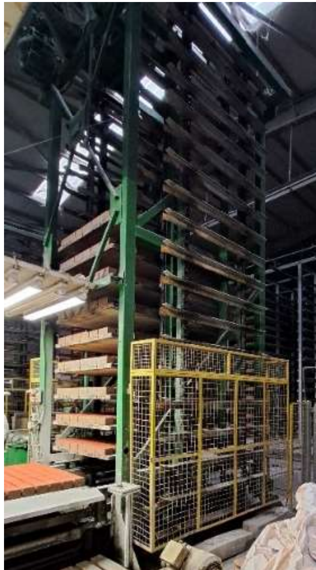
Slika 19. Podizanje betonskih elemenata na transporter za sušaru
