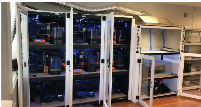
Slika 15. Smanjenje štetnog utjecaja aerosola ventilacijom. [32]
