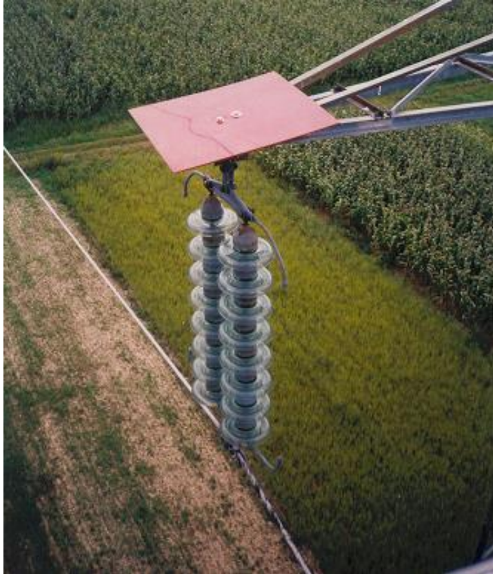
Slika 23: Prikaz zaštite izolatorskog lanca od životinja
