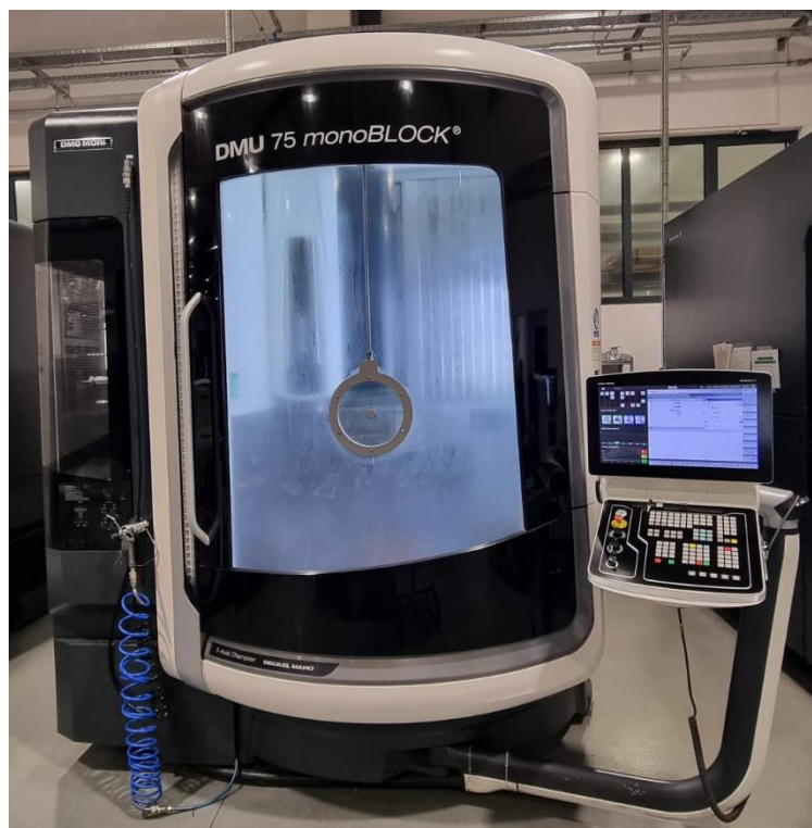
Slika 20. Zatvorena sigurnosna vrata na 5-osnoj glodalici
