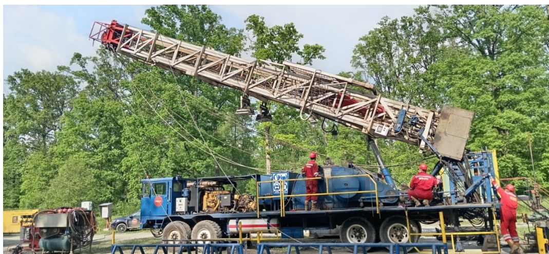
Slika 14. Podizanje prve sekcije tornja RP NAT-3 [3]
