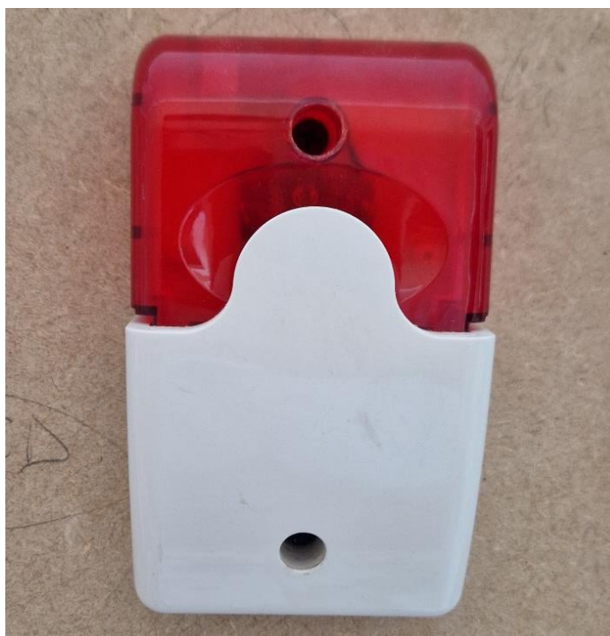
Slika 25. SIR 02 (EAS-400A) Unutarnja sirena
