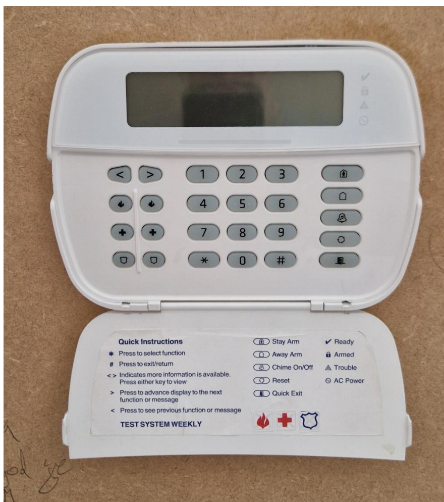
Slika 16. LCD tipkovnica HS2LCDEE3
