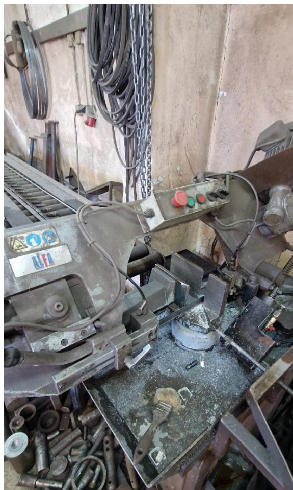
Slika 2. Tračna pila za metal
