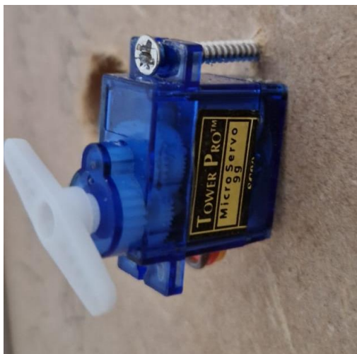
Slika 28. Servo motor Tower Pro Micro Servo 9g
