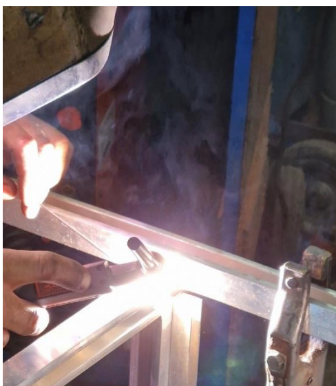
Slika 4. TIG zavarivanje s dodavanjem žice
