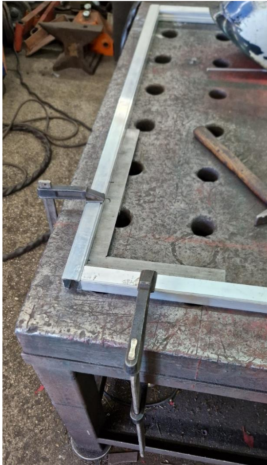
Slika 7. Stol za zavarivanje
