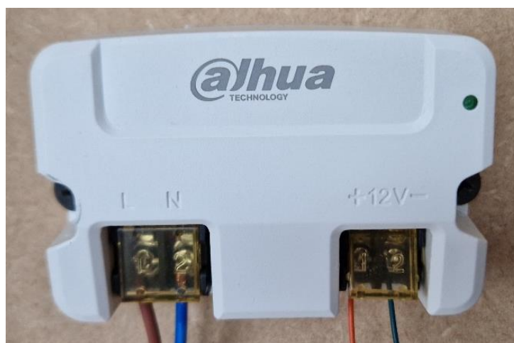
Slika 13. Strujni adapter Dahua DH-PFM320D-015
