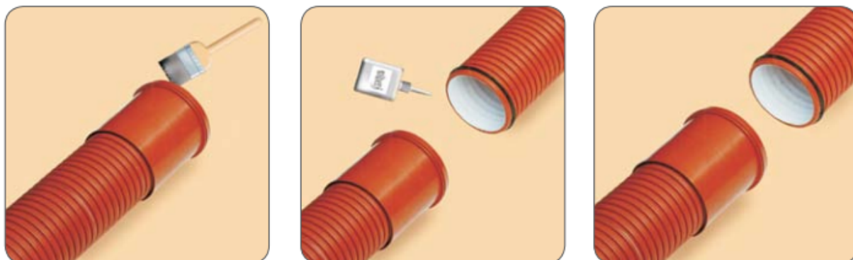
Slika 40: Princip spajanja cijevi[33]
