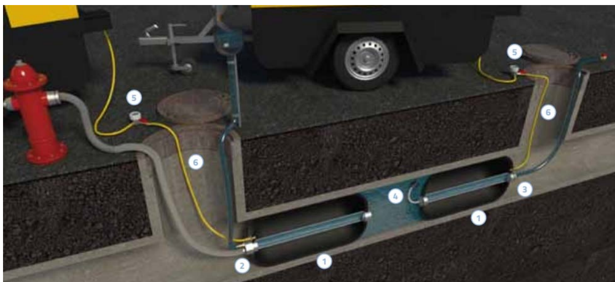
Slika 41: Princip ispitivanja cjevovoda vodom; 1.Zatvoreni gumeni balon odgovarajućeg promjera; 2.Protočni gumeni balon Slika 43: Kompresor zana balon (Storz); 4. Sonda za mjerenje tlaka; 5. Manometar sa sigurnosnim ventilom; 6.Crijevo za tlačenje balona [37]
