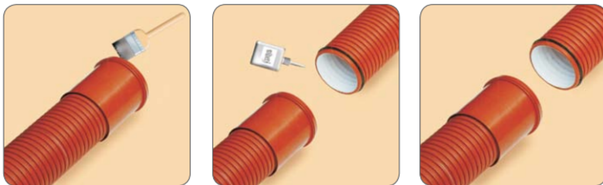
Slika 40: Princip spajanja cijevi[33]
