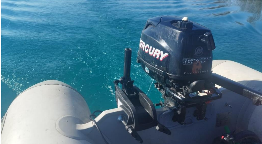
Slika 6. Položaj sonde na stražnjem kraju čamca
