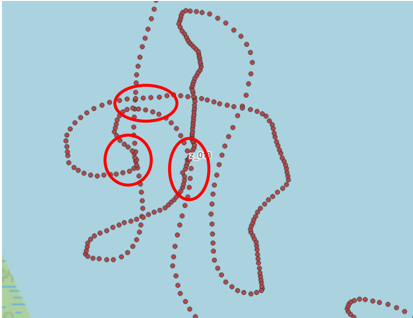
Slika 12. Prikaz lošije snimljenog lokaliteta, crvenom su označena preklapanja koja otežavaju čitanje snimka
