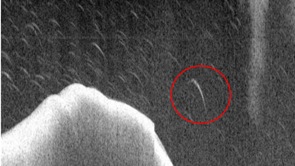
Slika 16. Prikaz ribe (označeno crveno) na snimci, pozadinske smetnje mogu izgledati kao manje jedinke no u ovom slučaju nisu
