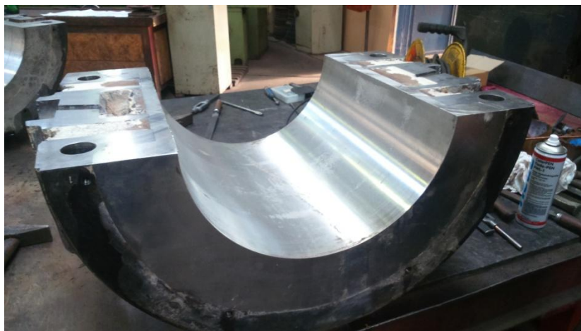
Slika 75: Očišćena gornja polovica ležaja prije nanošenja penetranta
