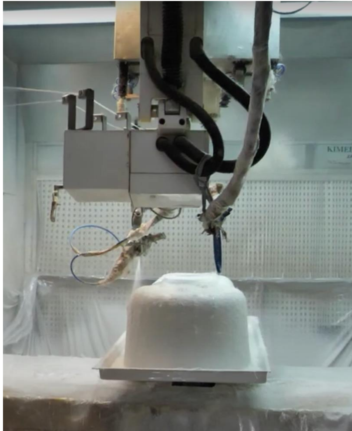
Slika 18. Robot za automatsko nanošenje ojačanja. Izvor: Aquaestil.hr
