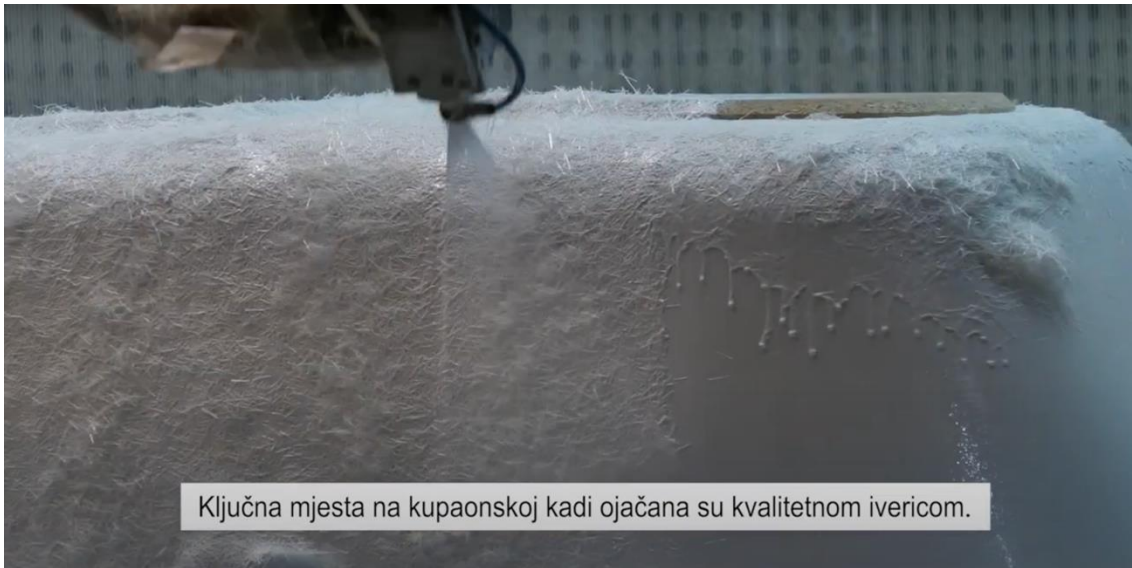
Slika 19. Nanošenje sloja ojačanja. Izvor: Aquaestil.hr
